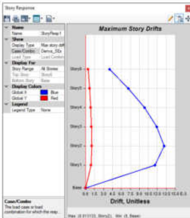
Figura 85. Gráfico de deriva máxima en el Eje X sin aisladores sísmicos.
