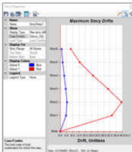
Figura 87. Gráfico de deriva máxima en el Eje Y sin aisladores sísmicos.
