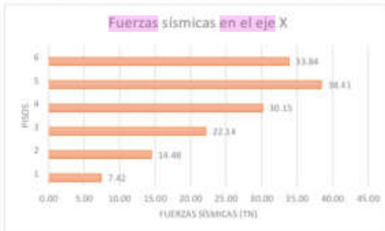
Figura 88. Distribución de fuerzas sísmicas en el eje X sin aisladores sísmicos
