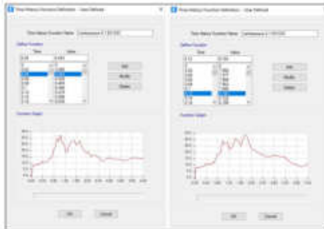
Figura 43. Inserción de los registros acelerométricos del Sismo Lambayeque
