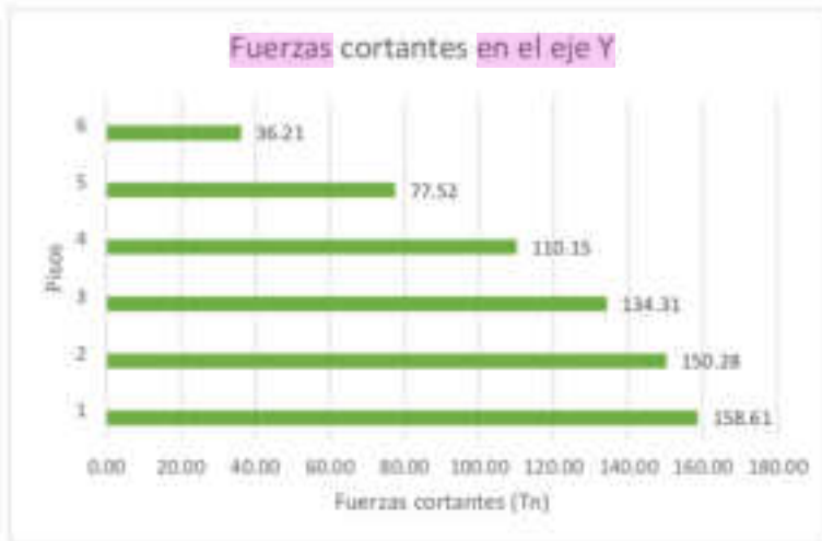
Figura 91. 2 Distribución de fuerzas cortantes en el eje Y sin aisladores sísmicos
