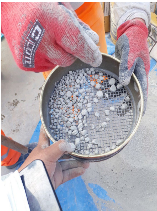
Foto 35. Tamizado del gout (Fuente: Consorcio Hospital Tacna - Hospital Hipólito Unanue de Tacna, 2018).
