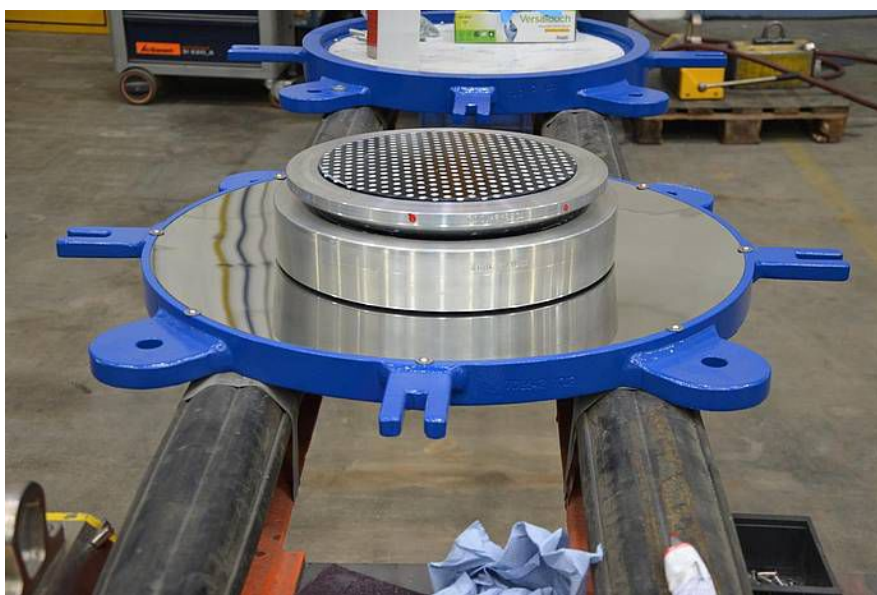
Figura 13. Aislador de deslizamiento (Fuente: http://www.archiexpo.es/prod/maurerse/product-126637-1907634.html ). El péndulo de deslizamiento adaptable permite reducir a un valor mínimo la aceleración absoluta pico de la estructura.
