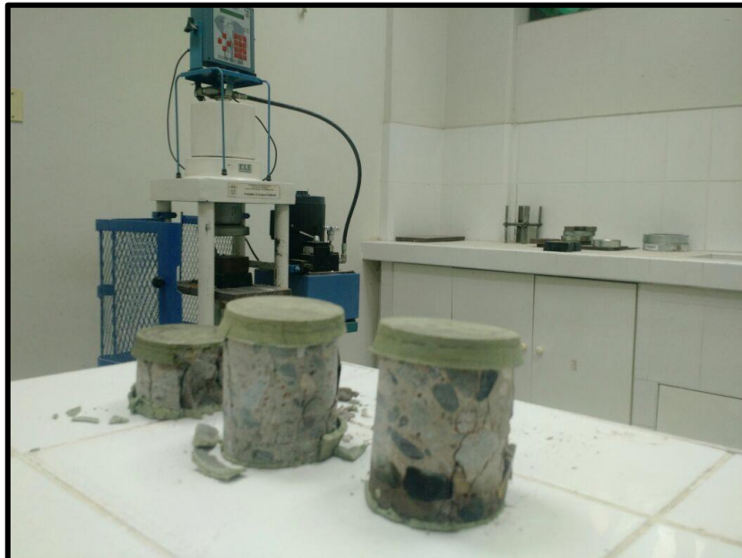
Imagen 13 Ensayo de compresión axial del concreto
