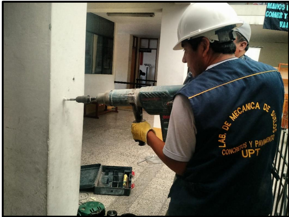
Imagen 02 Proceso de extracción de testigo
