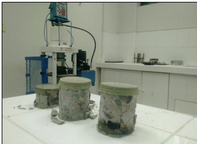
Figura 09. Testigos de concreto
