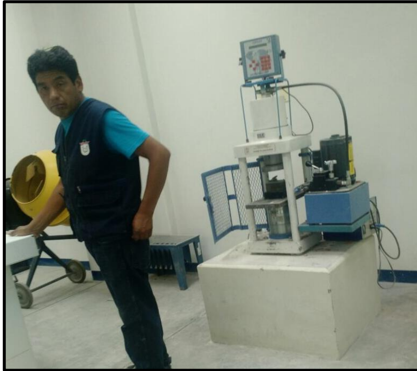
Imagen 12 Ensayo de compresión axial del concreto
