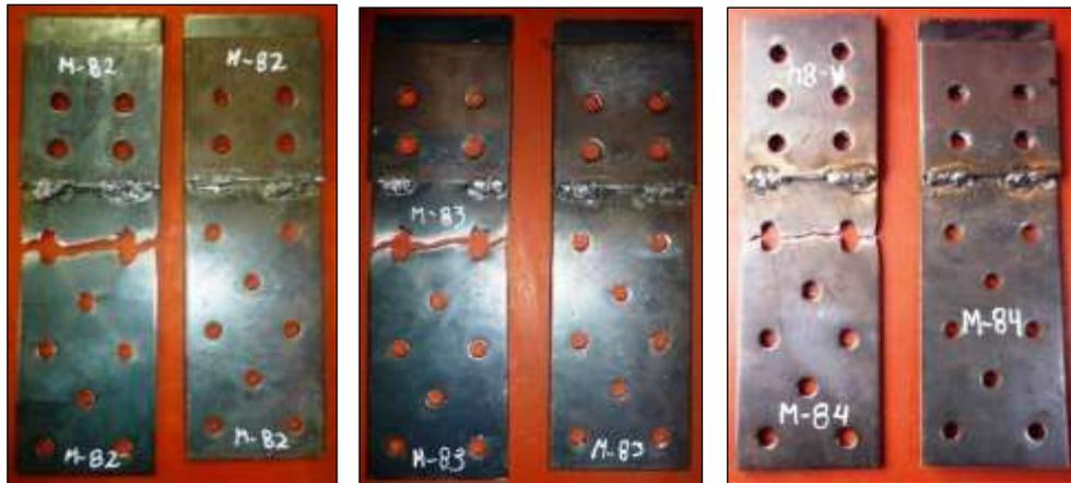
Figura N° 4.28 Probetas ensayadas de acero A-50 E=1/4" (M-82, M-83 y M-84)
