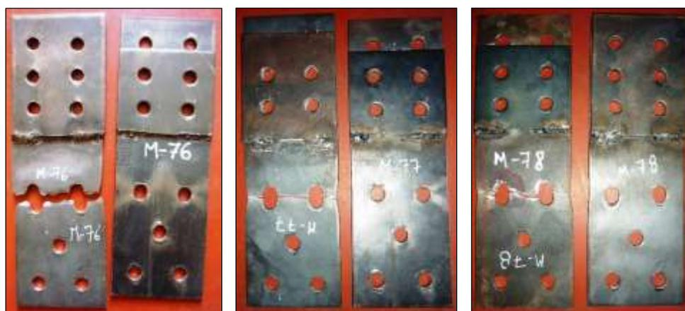
Figura N° 4.26 Probetas ensayadas de acero A-50 E=1/4" (M-76, M-77 y M-78)
