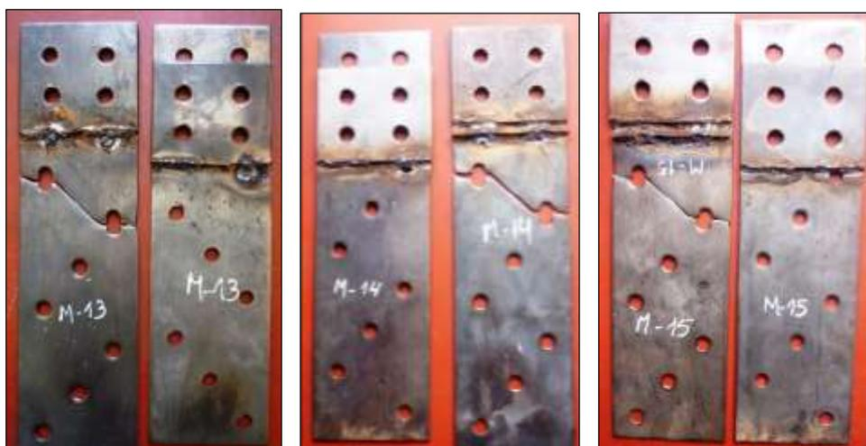
Figura N° 4.5 Probetas ensayadas de acero A-36 E=1/8" (M-13, M-14 y M-15)
