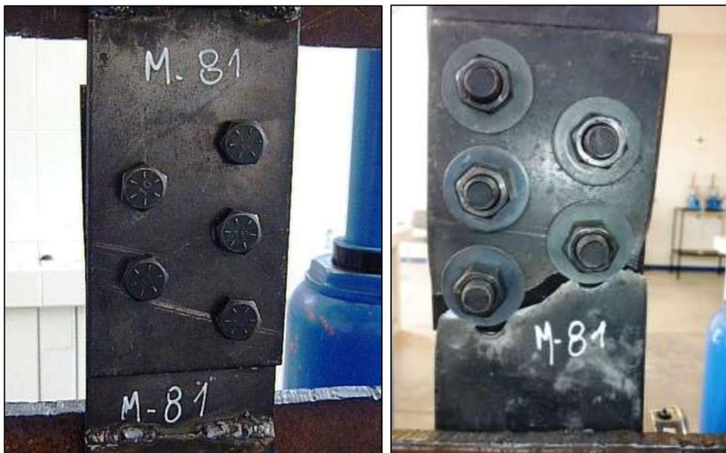
Vista antes y después de rotura, ensayo de tracción conexión tipo 02, en Laboratorio de Universidad Privada de Tacna.
