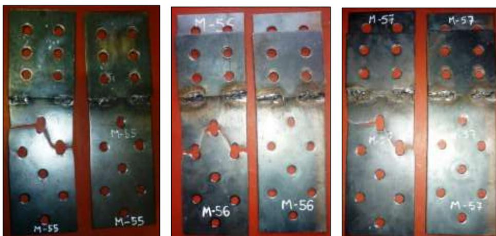
Figura N° 4.19 Probetas ensayadas de acero A-50 E=1/8" (M-55, M-56 y M-57)
