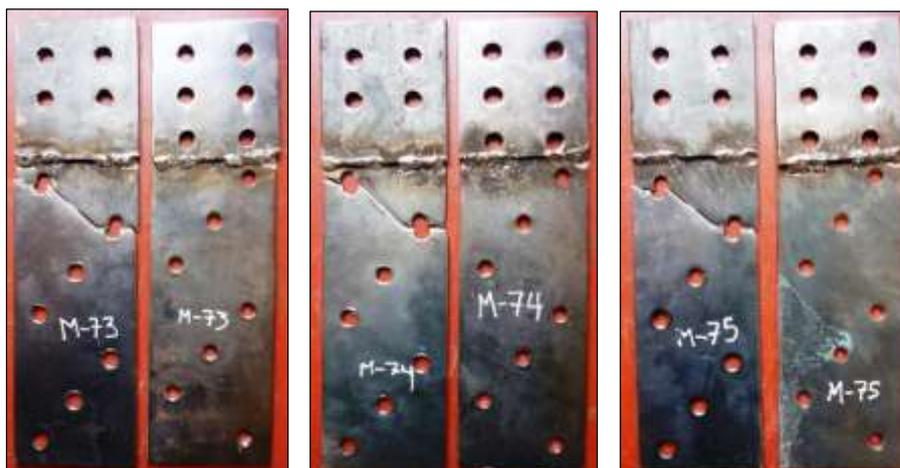
Figura N° 4.25 Probetas ensayadas de acero A-50 E=3/16" (M-73, M-74 y M-75)
