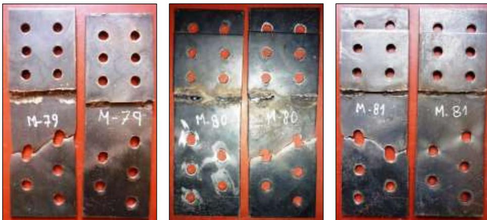
Figura N° 4.27 Probetas ensayadas de acero A-50 E=1/4" (M-79, M-80 y M-81)
