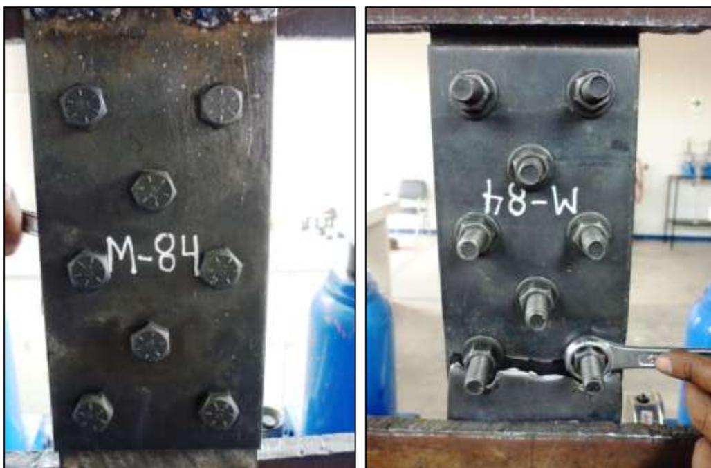
Vista antes y después de rotura, ensayo de tracción conexión tipo 03, en Laboratorio de Universidad Privada de Tacna.
