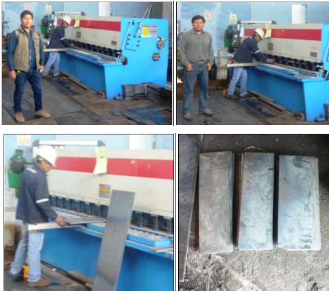
Proceso de corte de platinas de acero en taller.
