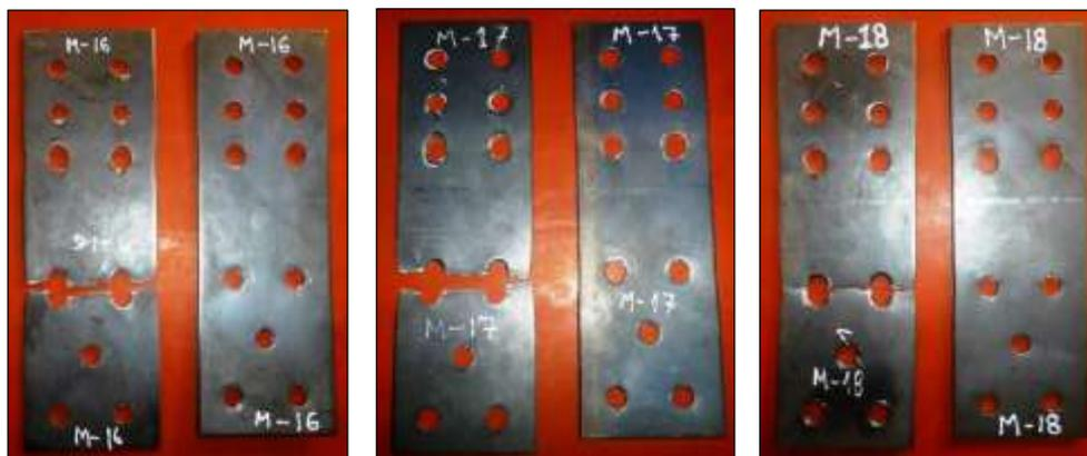
Figura N° 4.6 Probetas ensayadas de acero A-36 E=3/16" (M-16, M-17 y M-18)
