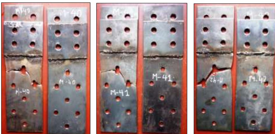
Figura N° 4.14 Probetas ensayadas de acero A-36 E=1/4" (M-40, M-41 y M-42)
