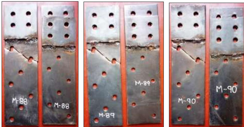
Figura N° 4.30 Probetas ensayadas de acero A-50 E=1/4" (M-88, M-89 y M-90)
