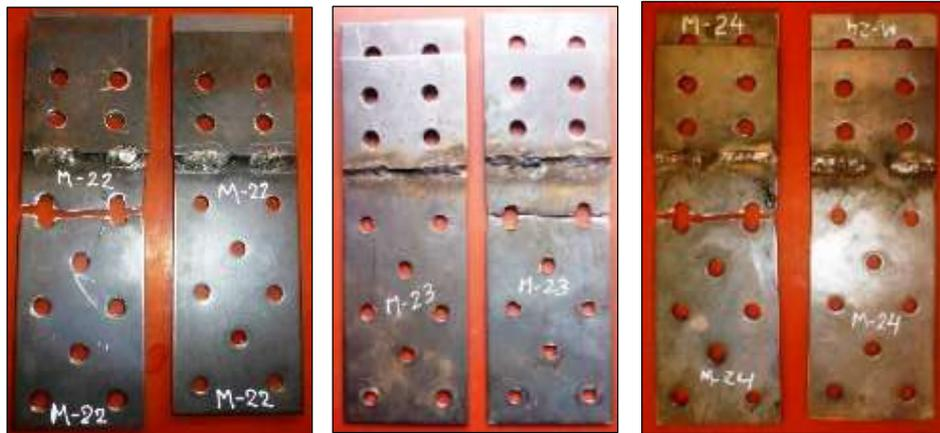
Figura N° 4.8 Probetas ensayadas de acero A-36 E=3/16" (M-22, M-23 y M-24)
