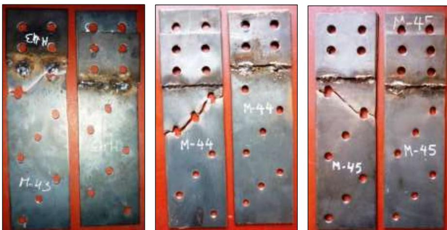
Figura N° 4.15 Probetas ensayadas de acero A-36 E=1/4" (M-43, M-44 y M-45)
