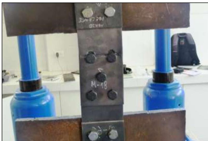
Vista antes y después de rotura, ensayo de tracción conexión tipo 01, en Laboratorio de Universidad Privada de Tacna.
