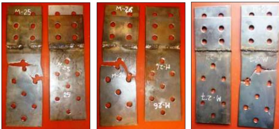
Figura N° 4.9 Probetas ensayadas de acero A-36 E=3/16" (M-25, M-26 y M-27)
