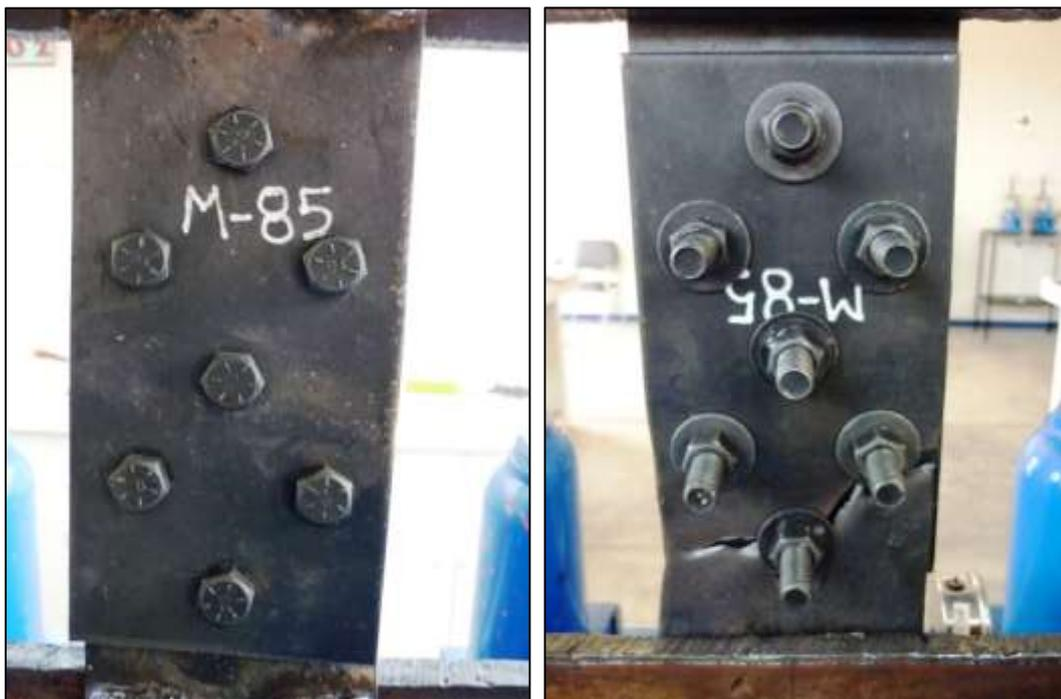
Vista antes y después de rotura, ensayo de tracción conexión tipo 04, en Laboratorio de Universidad Privada de Tacna.
