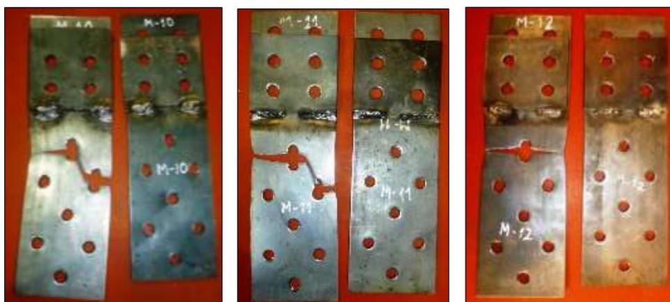
Figura N° 4.4 Probetas ensayadas de acero A-36 E=1/8" (M-10, M-11 y M-12)
