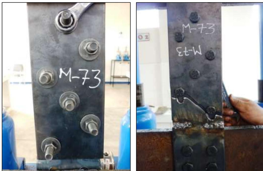
Vista antes y después de rotura, ensayo de tracción conexión tipo 05, en Laboratorio de Universidad Privada de Tacna
