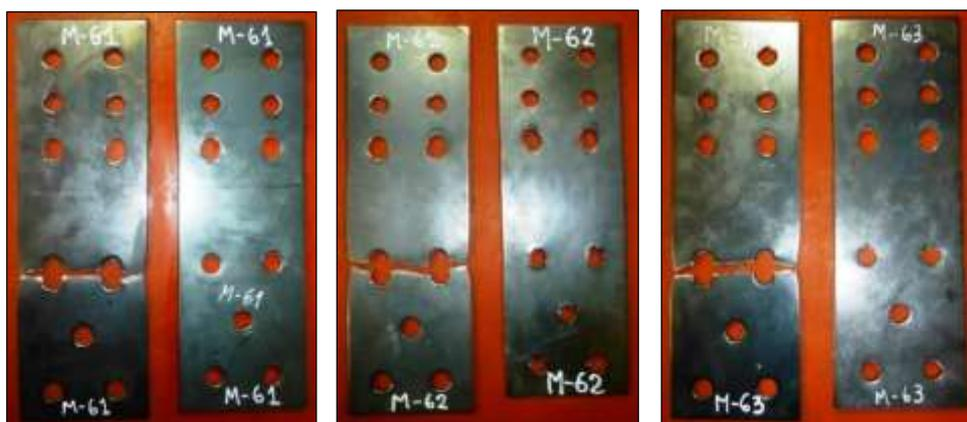
Figura N° 4.21 Probetas ensayadas de acero A-50 E=3/16" (M-61, M-62 y M-63)
