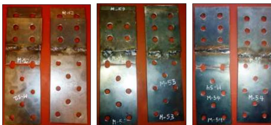
Figura N° 4.18 Probetas ensayadas de acero A-50 E=1/8" (M-52, M-53 y M-54)
