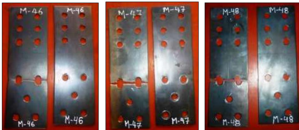
Figura N° 4.16 Probetas ensayadas de acero A-50 E=1/8" (M-46, M-47 y M-48)
