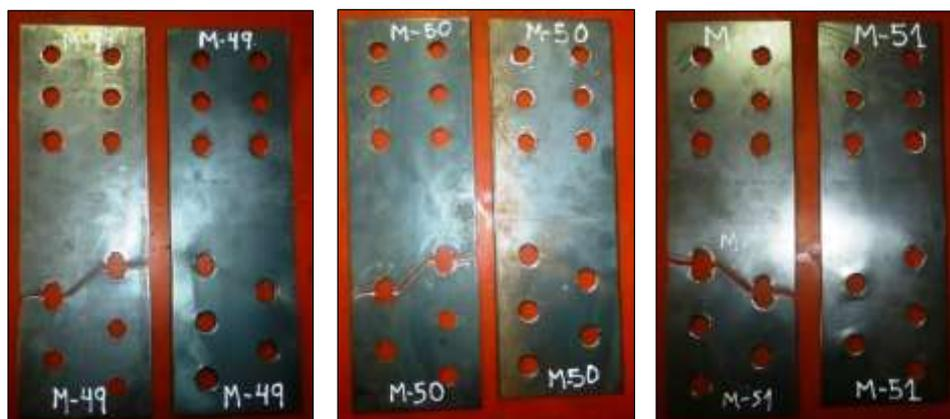
Figura N° 4.17 Probetas ensayadas de acero A-50 E=1/8" (M-49, M-50 y M-51)
