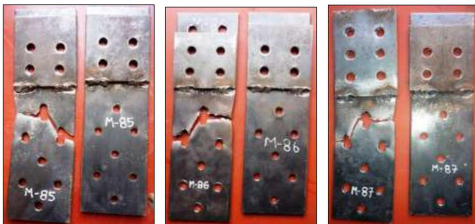
Figura N° 4.29 Probetas ensayadas de acero A-50 E=1/4" (M-85, M-86 y M-87)
