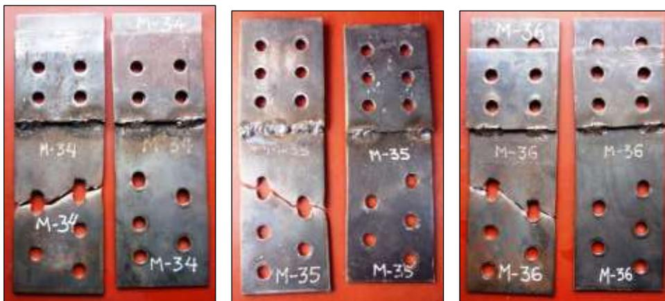
Figura N° 4.12 Probetas ensayadas de acero A-36 E=1/4" (M-34, M-35 y M-36)
