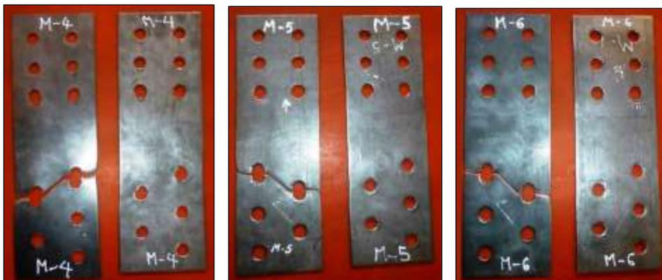
Figura N° 4.2 Probetas ensayadas de acero A-36 E=1/8" (M-4, M-5 y M-6)
