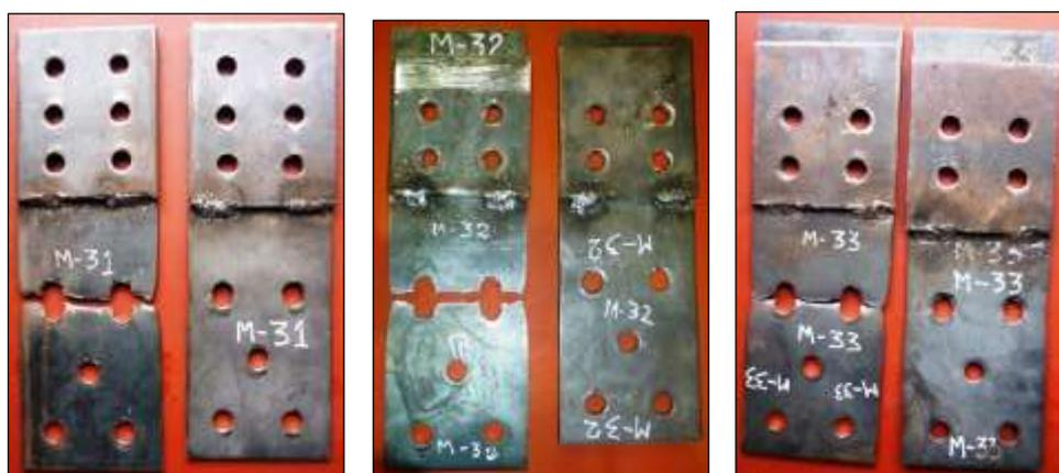
Figura N° 4.11 Probetas ensayadas de acero A-36 E=1/4" (M-31, M-32 y M-33)
