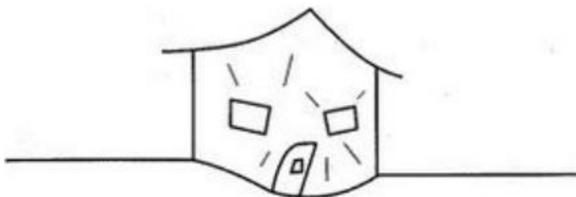
Figura 11. Asentamiento diferencial por (Coduto, 2001)
