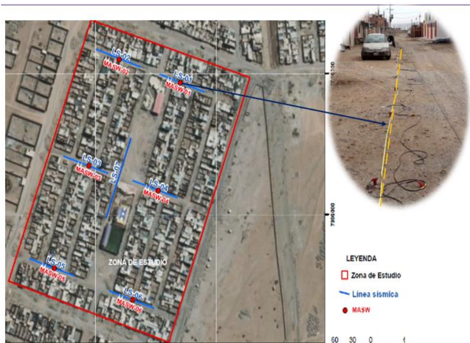
Figura 25. Ubicación de los puntos del ensayo de Análisis Multicanal de Ondas Superficiales (MASW)
