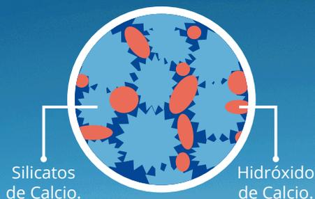
El cemento Tipo I produce un 75% de silicatos de calcio (resistencia), el otro 25 % es hidróxido de calcio que no ofrece resistencia y es susceptible a los ataques químicos, produciendo erosiones y/o expansiones.
