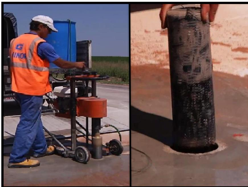
**FIGURA 8: EXTRACCIÓN DE TESTIGOS (DIAMANTINAS) PARA SER ENSAYADAS COMO CONTROL DE CALIDAD DE ADHERENCIA**
