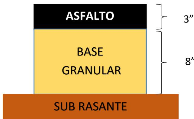
Figura N°29. Diseño preliminar de estructura del pavimento
