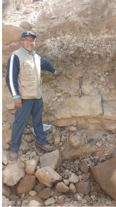
Figura 36: Depósito Coluvial representada por bloques y cantos rodados de areniscas tobáceas, que están cubiertas por una delgada capa de depósito Coluvio Deluvial.
