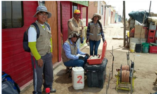
Figura 42: SEV 02, efectuado en el talud del Cerro Intiorko sobre materiales secos limo-arcillosos. Se observa el equipo de resistividad eléctrica con cables de emisión de corriente, carretes, electrodos y personal técnico.
