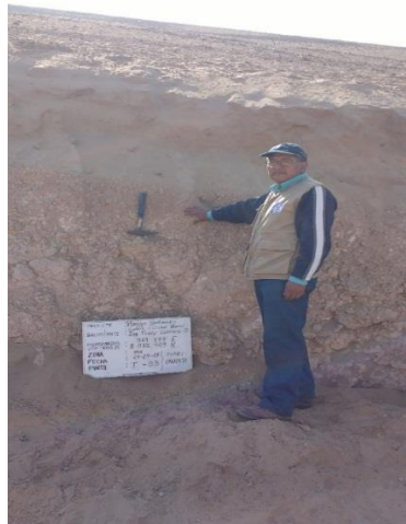
Figura 35: Depósito Coluvial representada por tobas volcánicas muy a extremadamente fracturadas.
