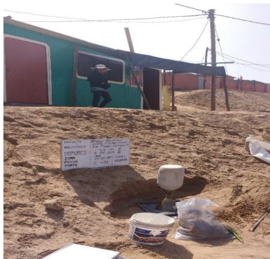
Figura 43: Perfil estratigráfico de la calicata N° 01 clasificado como un suelo areno limoso (SM). Se observa la prueba de densidad de campo.
