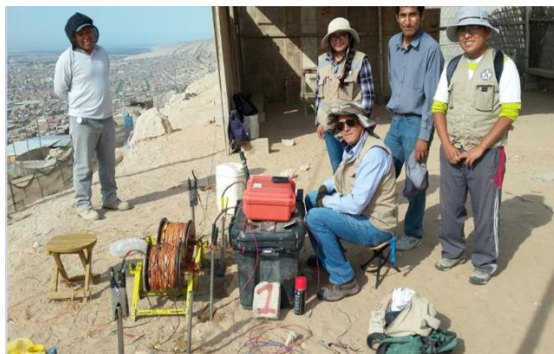
Figura 41: Personal técnico y equipo de resistividad eléctrica preparados para empezar a realizar el SEV 01 en el Cerro Intiorko sobre materiales secos limo-arcillosos.
