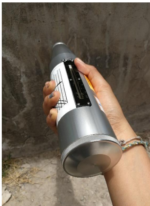
Figura N° 14: Registro de resistencia de la estructura con el esclerometro
