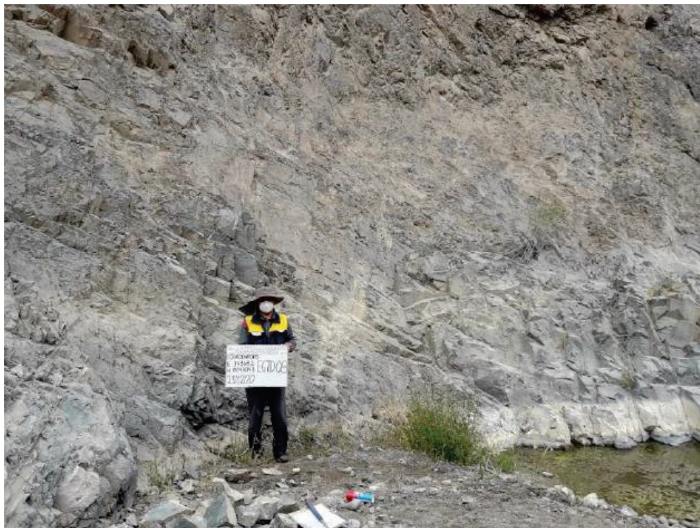
Foto N° 20. En la siguiente imagen se puede apreciar la Estación Geomecánica EGTD – 08, de un afloramiento de roca plutónica monzodiorita que tiene un grado medio de intemperismo, cercana a la estructura proyectada del eje del túnel de desvío.
