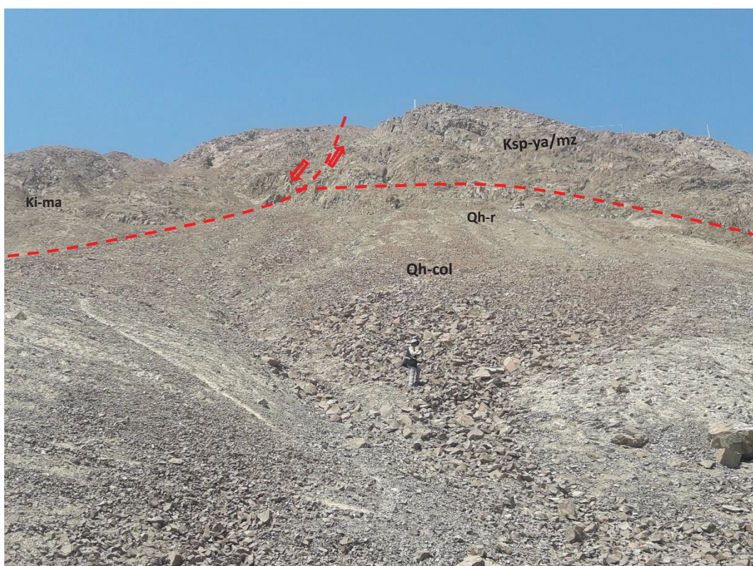
Foto N° 5: Vista del afloramiento del cuerpo ígneo – plutónico del Stock Yarabamba en el margen derecho de la desembocadura de la quebrada Toro Muerto, compuesto de Monzodioritas, monzonitas y adamelitas. Este macizo presenta xenolitos que son trozos trozos de roca que cayeron al magma sin fundirse en el estribo derecho del eje de la presa proyectada y la parte alta del cerro mostrado.
