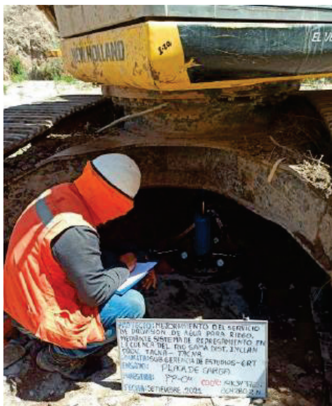
Foto N° 17. Ensayo de Densidad in situ a una profundidad de 1.0 m. en la Calicata PP-01 (CEP-04) (ASTM D-1556,
