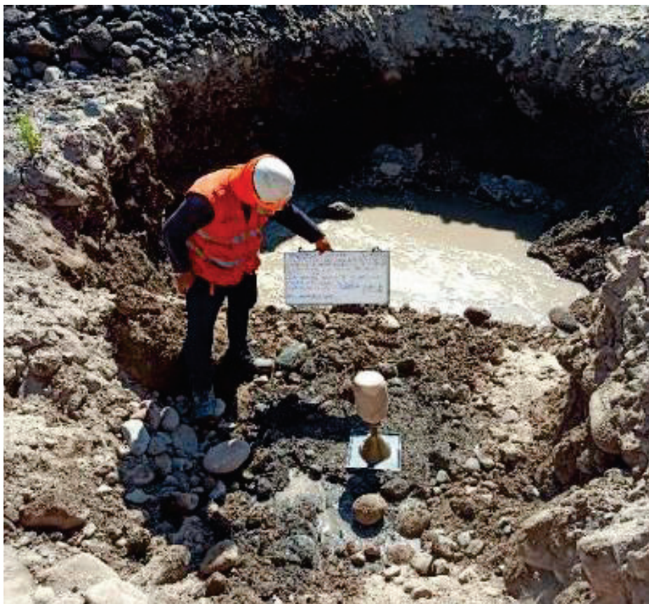
Foto N° 17. Ensayo de Densidad in situ a una profundidad de 1.0 m. en la Calicata PP-01 (CEP-04) (ASTM D-1556,
