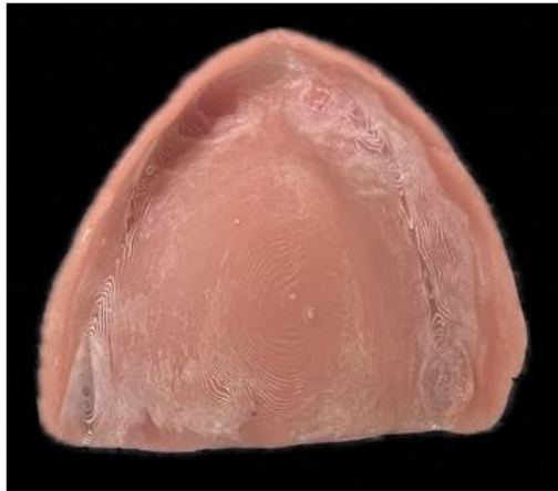
Figura 10: Efecto escalonado en la impresión 3D. Sulaya K, B V S, Nayak VM. The science of printing and polishing 3D-printed dentures. F1000Research. 23 de octubre de 2024;13:1266. (26)
