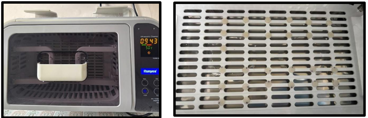
Figura 20: Limpieza de las muestras a través de baño ultrasónico
