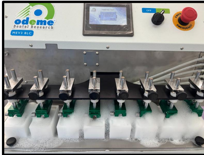
Figura 17: Simulación de Cepillado con Pasta Dental Blanqueadora por 50000 ciclos equivalentes a un año de cepillado
