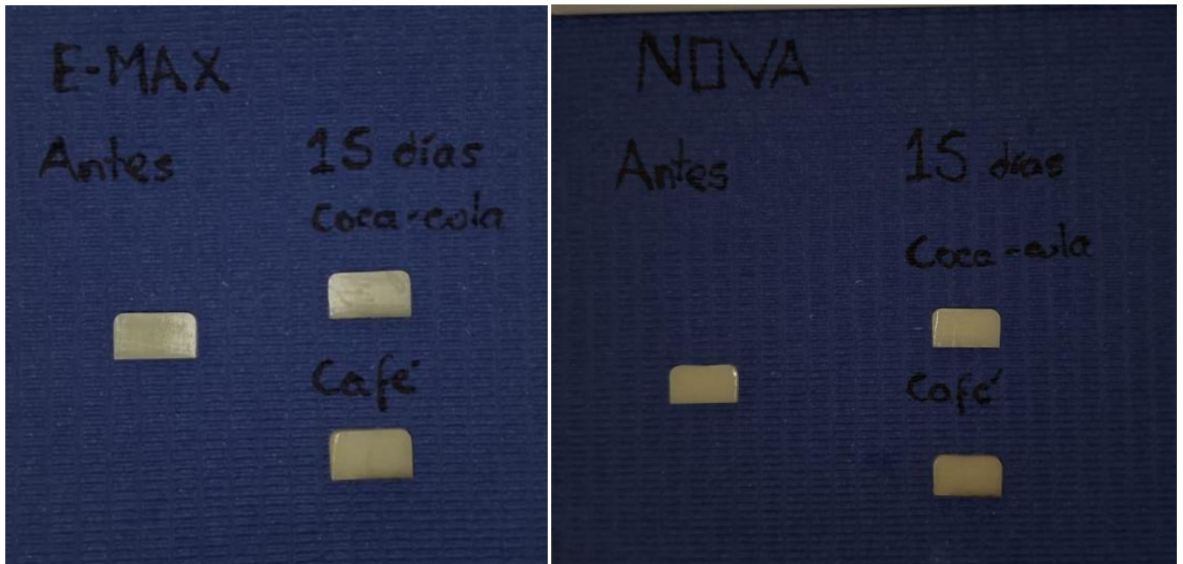
Anexo 18. Cambio de color de los especímenes de las dos marcas de disilicato de litio a los 15 días , observamos que ya a este día de inmersión se observan claros resultados de cambio de color.
