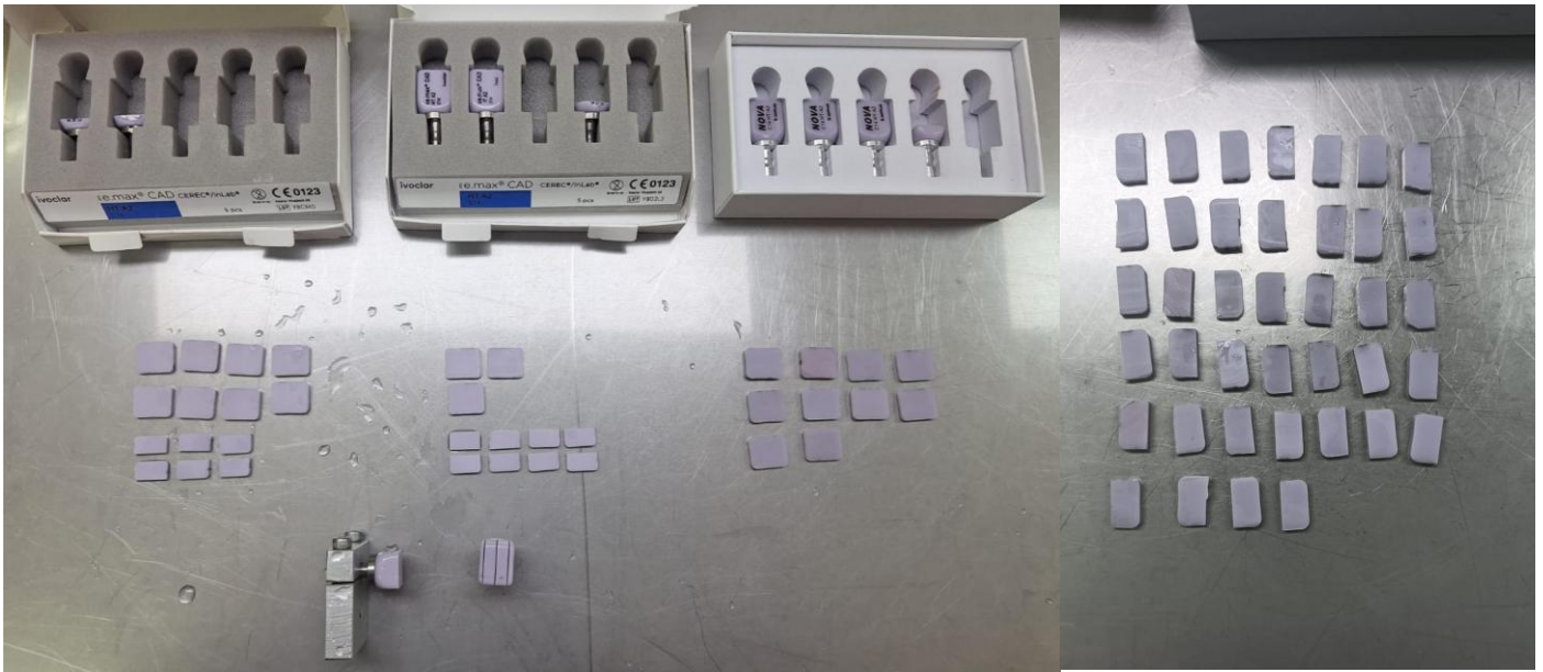
Anexo 4. Bloques de disilicato de litio CAD/CAM seccionados después del proceso de corte.
