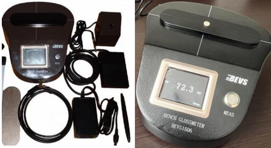
Anexo 11. Medición del brillo mediante un brillómetro de banco (BEVS1506)
