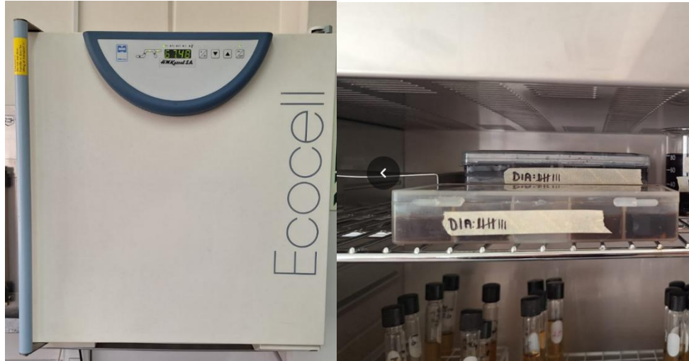
Anexo 17. Colocación de los especímenes en la incubadora EcoCell® (H.W. Kessel S.A., República Checa) a 37 \pm 1 °C.
