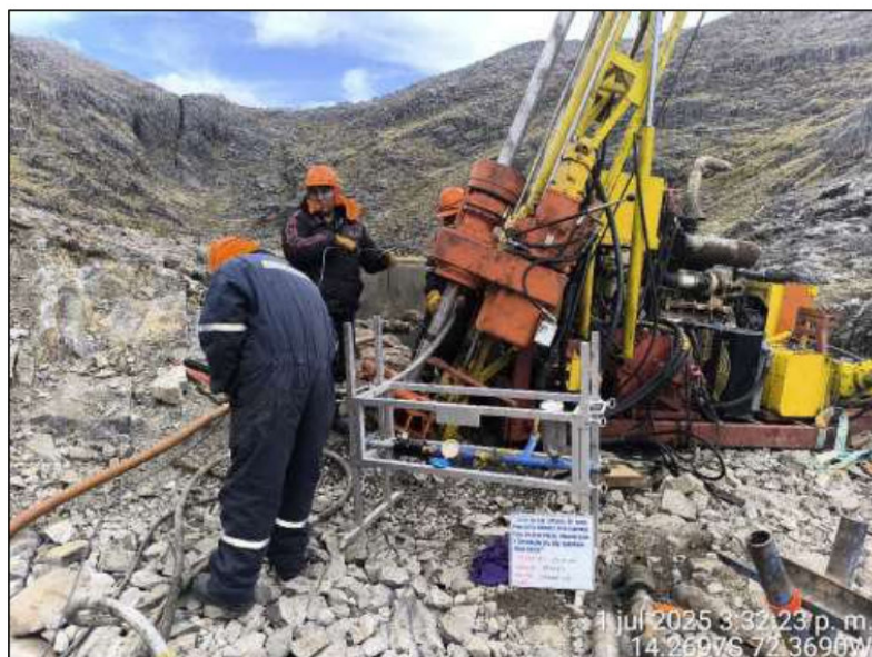
Fotografía N° 14: Vista Panorámica de Instalación e inflado de pakker para realizar la prueba de permeabilidad Lugeon.
