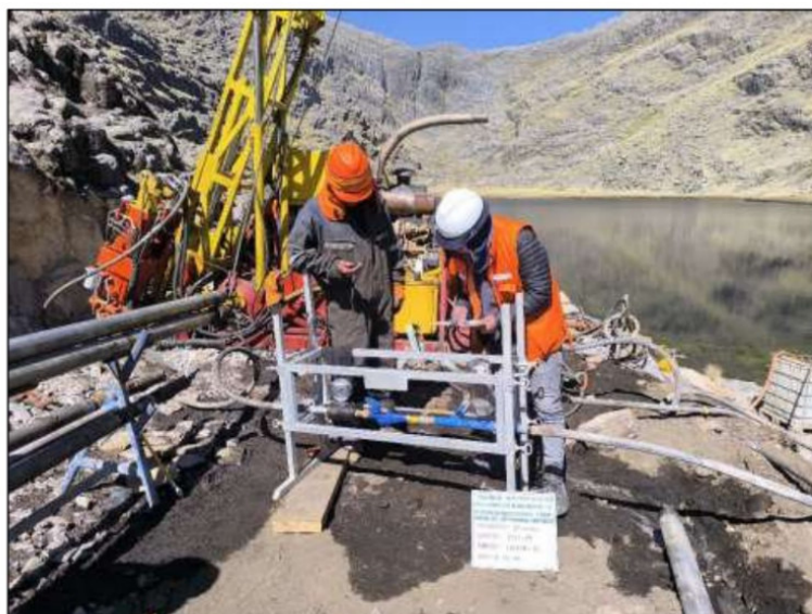
Fotografía N° 21: Registro de ensayo de permeabilidad Lugeon en campo, con participación de equipo técnico en la toma de datos de caudal.
