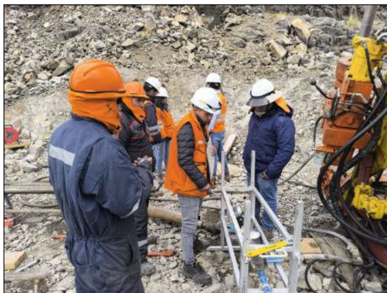
Fotografía N° 15: Vista Panorámica de personal técnico realizando toma de datos durante ensayo de permeabilidad en perforación diamantina Lugeon.
