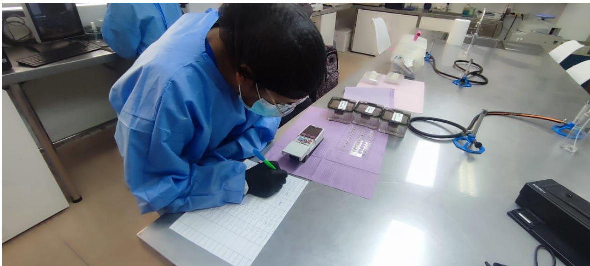
Fotografía 13: Fase de recolección de datos: Investigadora realizando el registro de los valores de rugosidad obtenidos con el rugosímetro Mitutoyo SurfTest-410.
