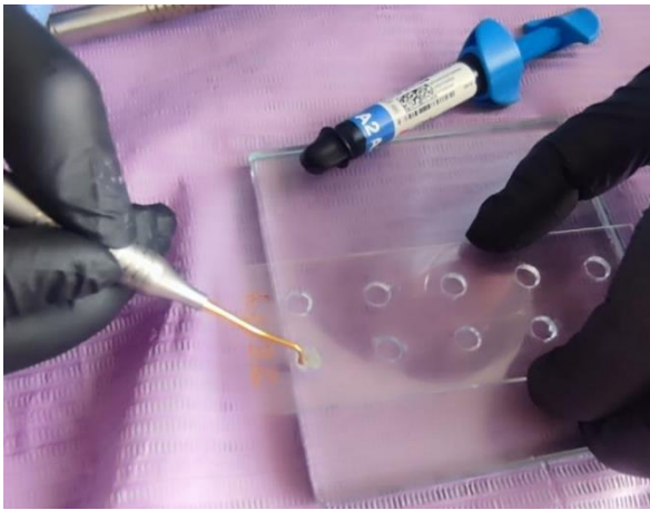
Fotografía 4: conformación de bloques de resina con la técnica incremental
