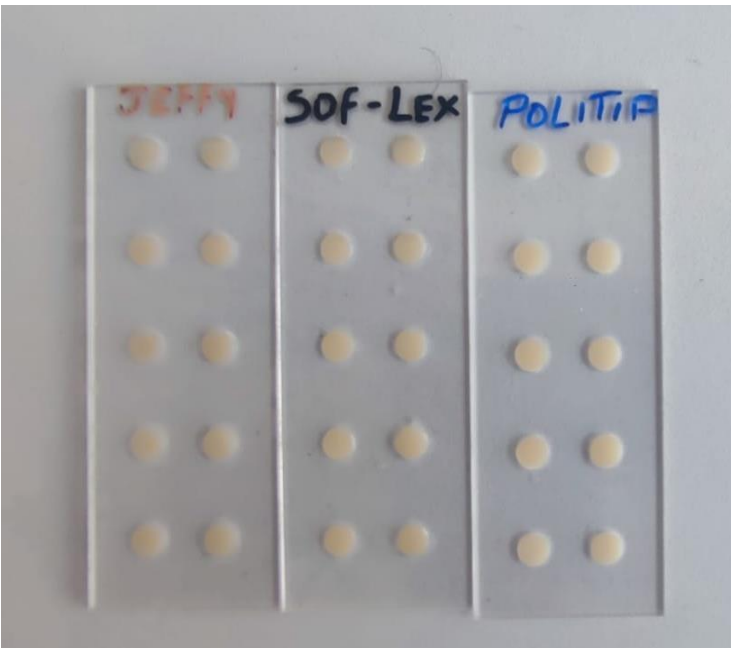
Fotografía 7 : placas acrílicas conformadas de resina Z350 3M y 10 muestras por cada sistema de pulido
