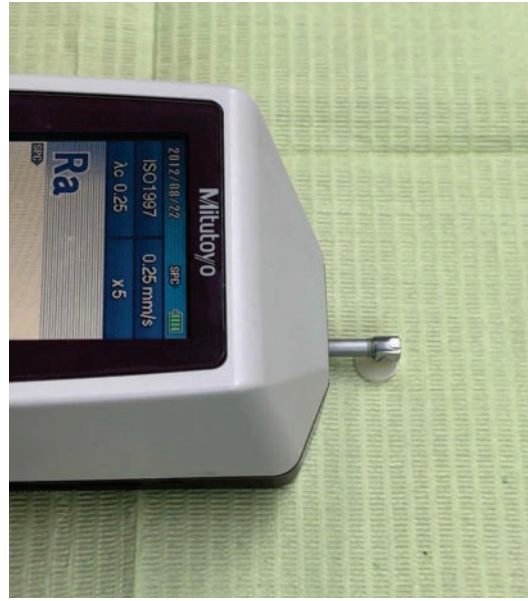
Figura A7.1. Toma de medidas con Rugosímetro Portátil (SJ-210; Mitutoyo, Aurora, IL, EE. UU.) Calibración del rugosímetro (A). Posicionamiento de la punta en la muestra de resina (B). Anotación de resultados (C)
