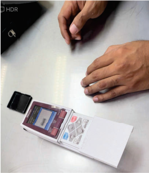
Figura A7.1. Toma de medidas con Rugosímetro Portátil (SJ-210; Mitutoyo, Aurora, IL, EE. UU.) Calibración del rugosímetro (A). Posicionamiento de la punta en la muestra de resina (B). Anotación de resultados (C)
