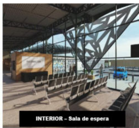
Pórtico y celosía - sombra y confort Doble vidrio con cámara de aire - envolvente térmico, Cubiertas inclinadas - mayor transpiración
