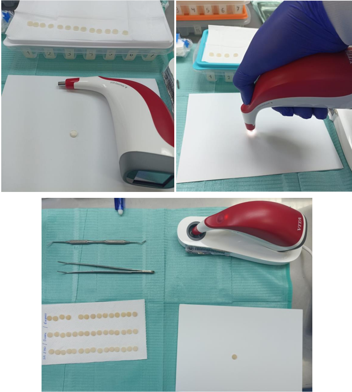
Figura 3. Medición con del color con espectrofotómetro Vita, antes de la exposición
