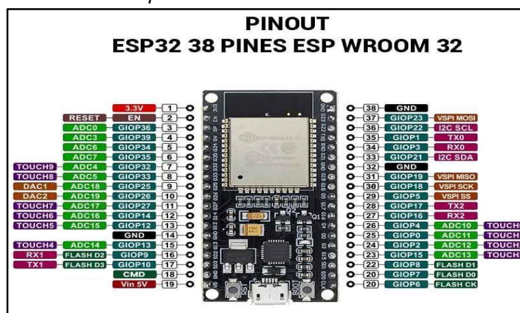
Figura 14 Distribución de pines del microcontrolador ESP32
