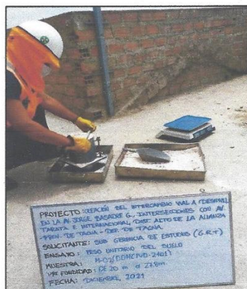
Fotografía N° 19: Ensayo de Peso unitario del suelo de la muestra M-02 (DDHCIVD-2101).
