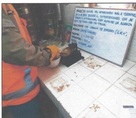
Fotografía N° 11: Límite de Atterberg - Limite Líquido (ASTM D 4318) de la muestra CB-01.
