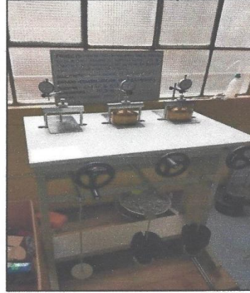
Fotografía N° 18: Ensayo de Consolidación (ASTM D 2435) de la muestra C-01 (CB-01).
