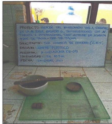
Fotografía N° 12: Límite de Atterberg - Límite Plástico (ASTM D 4318) de la muestra CB-01.
