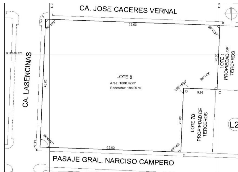
Figura 52: Plano perimétrico del terreno.
