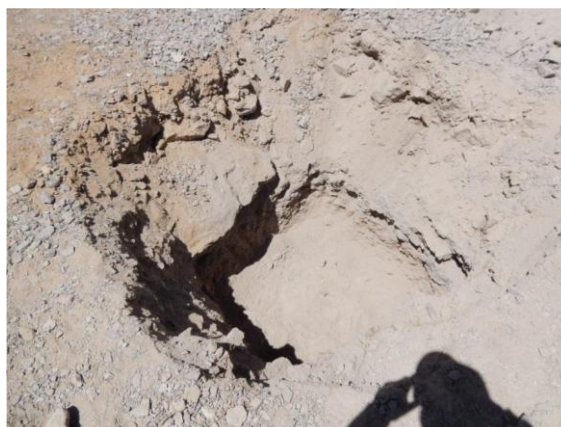
Figura 23: Calicata C-01 conformada por arenas limosas y arcillosas
