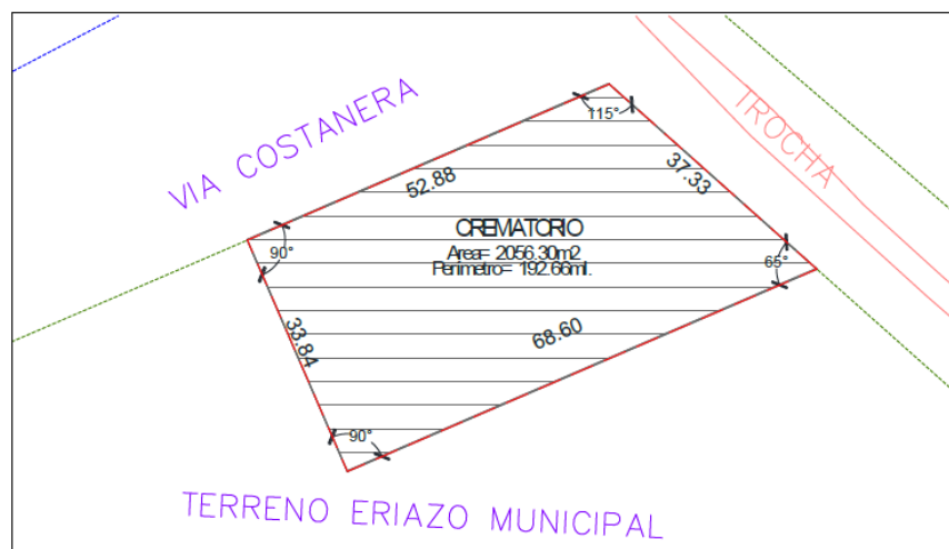
Figura 33: Plano perimétrico del proyecto
