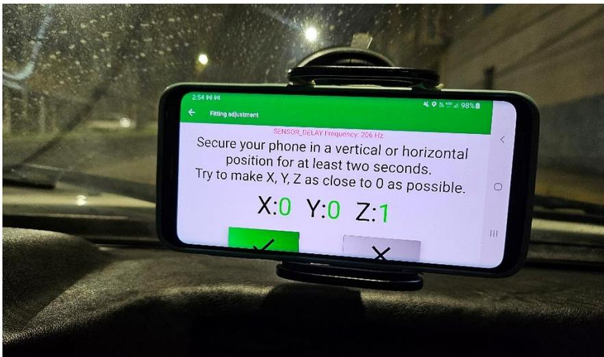
Nota. Se muestra el momento de la nivelación culminada de la aplicación ROADROID en el teléfono inteligente modelo Samsung Galaxy S9
