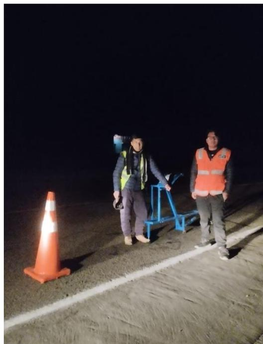
*Nota.* Se inició la medición en el kilómetro 8+000 a las 2:00 a.m. empleando el rugosímetro MERLIN, garantizando en todo momento la seguridad de los tesisistas mediante el uso de chalecos reflectantes y la correcta disposición de conos de señalización. Además, se contó con el apoyo de terceras personas, quienes colaboraron en temas de seguridad, asegurando un entorno controlado y libre de riesgos para todos los involucrados
