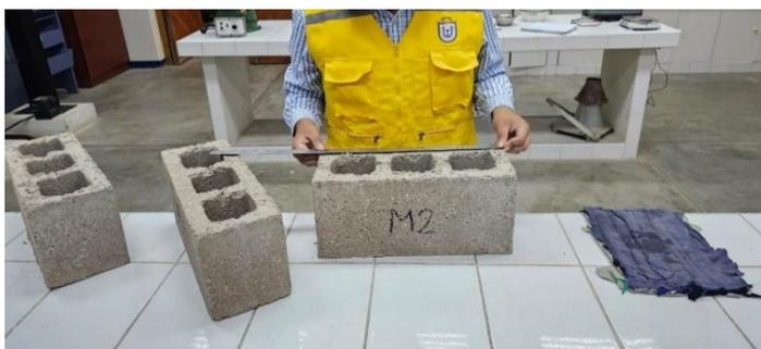
*Nota.* Medición de dimensiones de cada unidad de bloque de concreto mecanizado en el laboratorio de la UPT.
