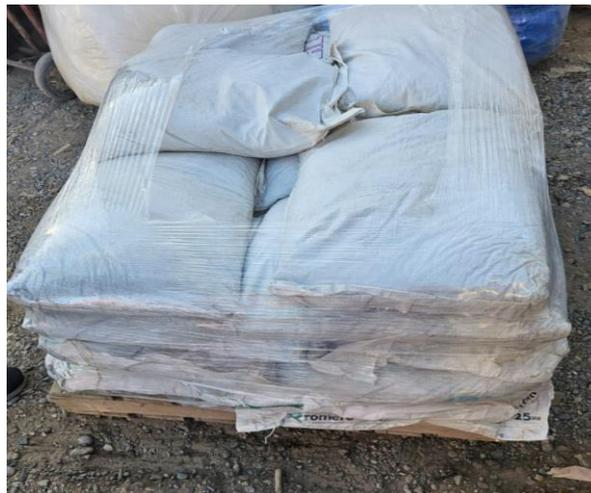
*Nota.* Agregado fino utilizado en la construcción de primas.
