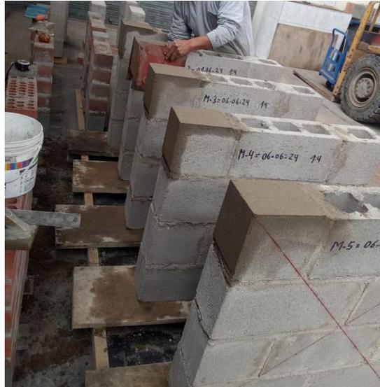
*Nota. Colocacion de capping en los extremos de los muretes en el laboratorio de CISMID.*
