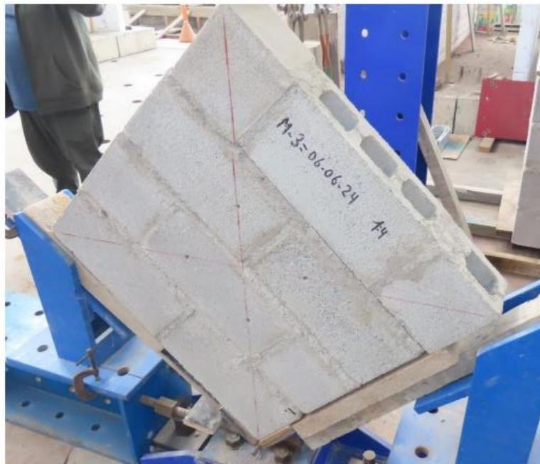
Foto 24. Murete M-3, Falla por deslizamiento.
