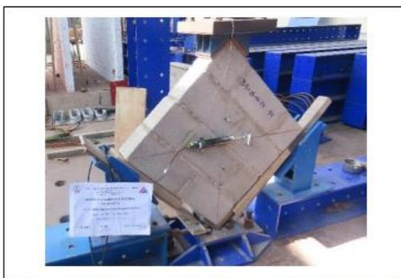
Figura 2 Ensayo de compresión diagonal
