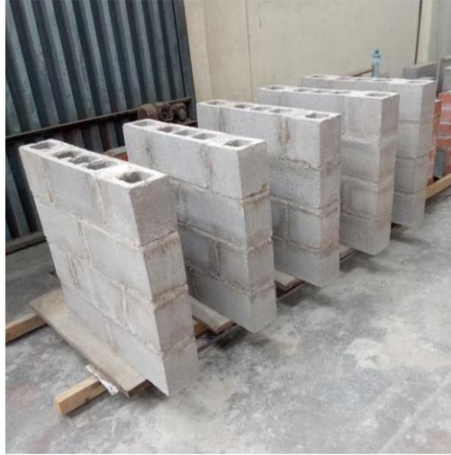
*Nota.* Murete de albañilería elaborada en el laboratorio de CISMID
