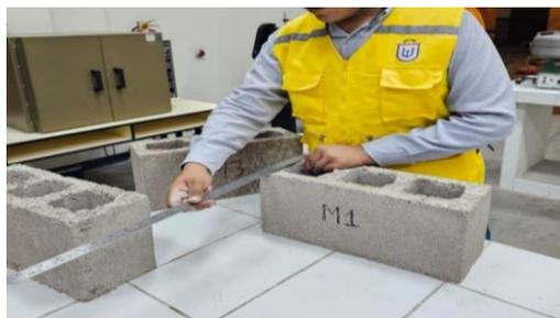
*Nota.* Medición de los alveolos de cada unidad de bloque de concreto mecanizado.
