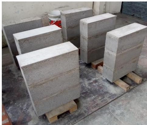
*Nota.* Colocacion de capping en las pilas en el laboratorio de CISMID.
