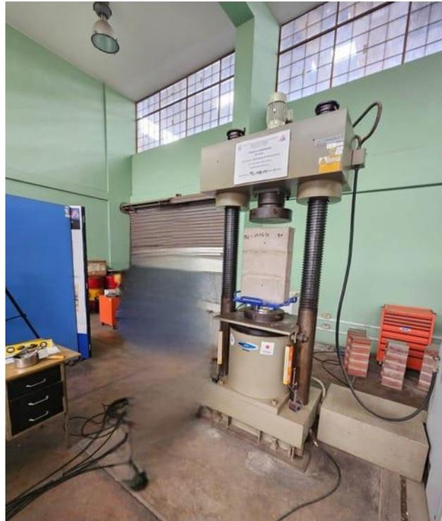
*Nota. Pila de albañilería ensayado en el laboratorio de CISMID.*
