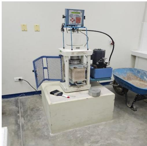
*Nota.* Bloque de concreto mecanizado ensayado para hallar  $f'_b$ .
