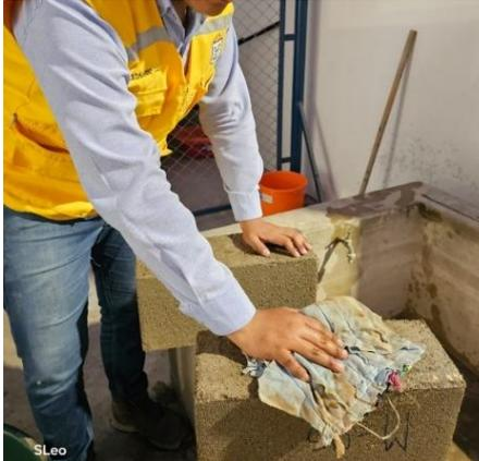
*Nota.* Proceso de secado de la unidad de bloque de concreto mecanizado
