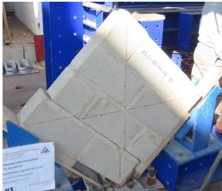
Foto 30. Murete M-5, Falla por deslizamiento
