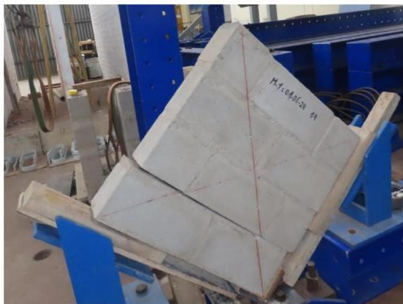
Foto 18. Murete M-1, Falla por deslizamiento
