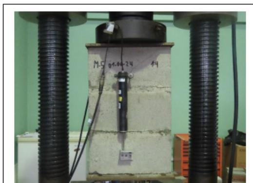
Figura 1 Ensayo de compresión axial
