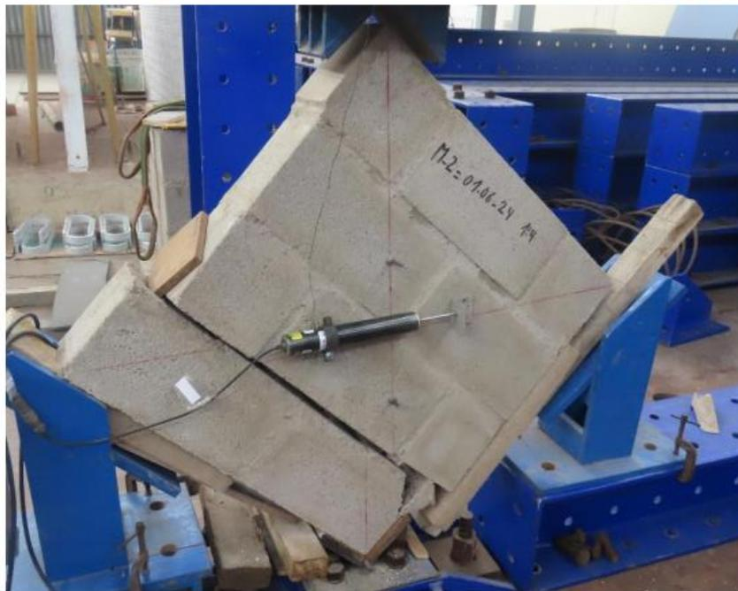
Foto 21. Murete M-2, Falla por deslizamiento.
