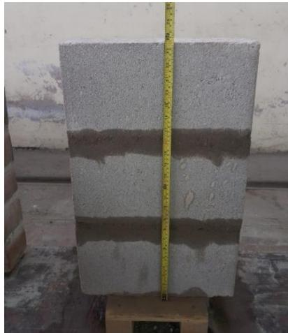
*Nota.* Pila de albañilería elaborada en el laboratorio de CISMID.
