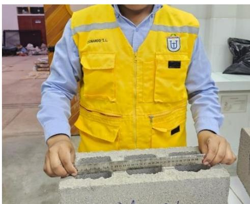
*Nota.* Medición de alabeo de cada unidad de bloque de concreto mecanizado en el laboratorio de la UPT.
