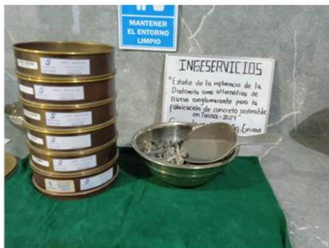
*FIGURA 3: Granulometría del agregado fino*
