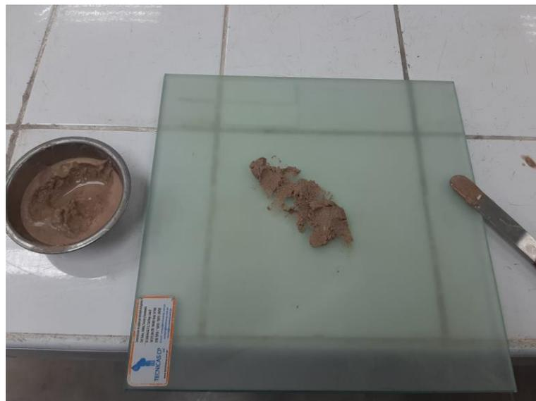
*Nota:* Se intentó realizar el ensayo de Límite líquido y plástico, sin embargo, el material no tiene características que se comporten de manera plástica
