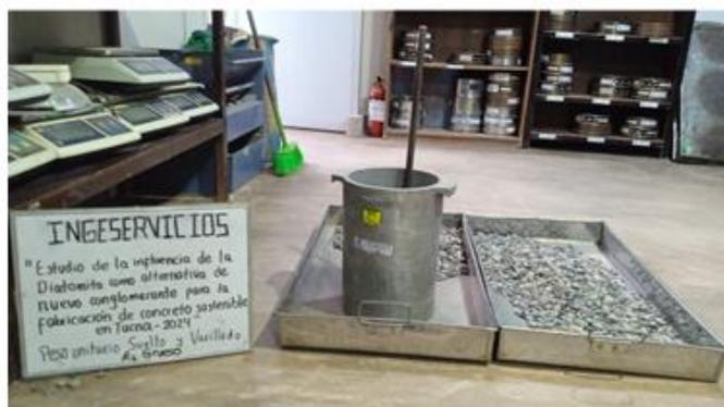
*FIGURA 5: Peso unitario suelto y compactado del agregado fino.*
