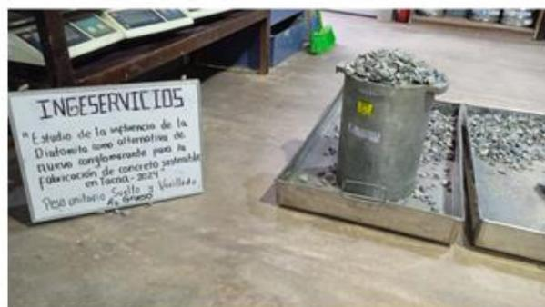
**FIGURA 7:** Peso unitario suelto y compactado del agregado grueso.
