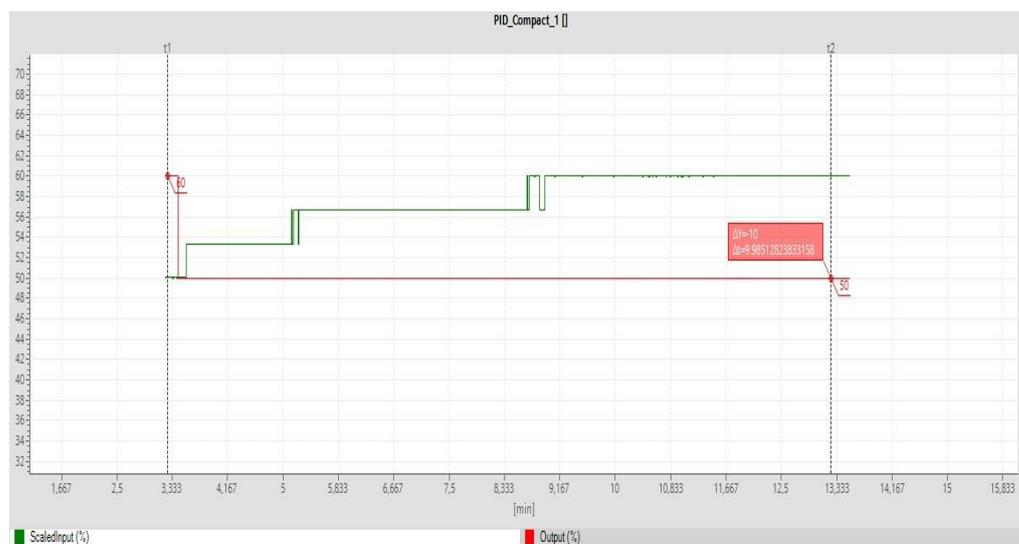
Nota: Gráfico del proceso en estado estable, manipulando la válvula proporcional de 60% a 50%.
