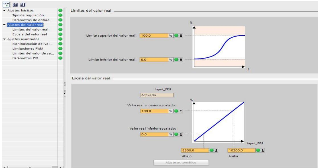
En este segmento se ajustó los límites de valor real que representan de 0 – 100 % y la escala para el sensor 5300 – 27640, obtenida manualmente, donde 5300 cierra la válvula proporcional totalmente y 27640 la abre totalmente.
