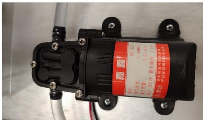
*Nota:* Imagen de la bomba para el bombeo de agua al depósito. Fuente Elaboración Propia [Imagen].
