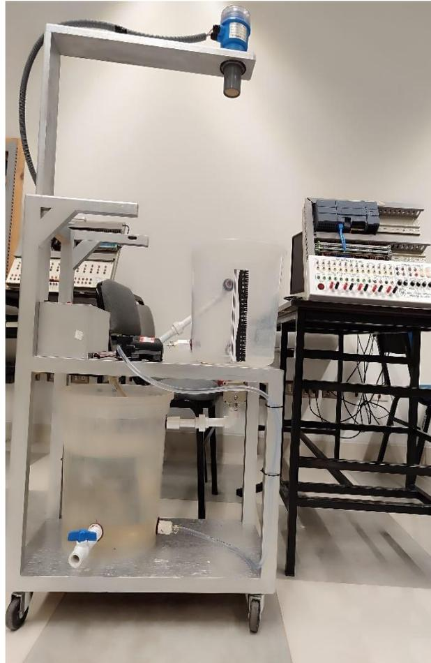
*Nota:* Módulo de Control de nivel Imagen Prototipo.
