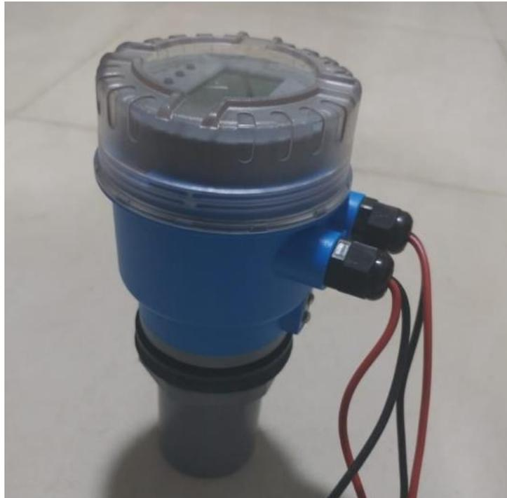
*Nota.* Imagen del sensor ultrasónico posicionado en la parte superior sobre el tanque donde se desea medir en nivel del agua. Elaboración propia [imagen].
