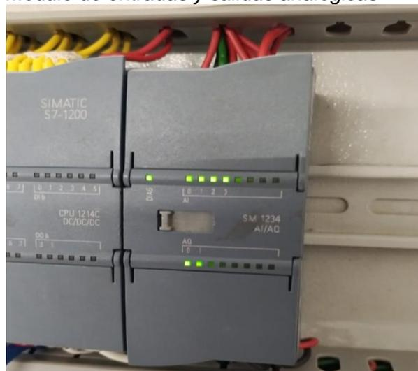
*Nota:* PLC Siemen S7-1200, módulo de entradas y salidas analógicas. Fuente Elaboración Propia [Imagen].
