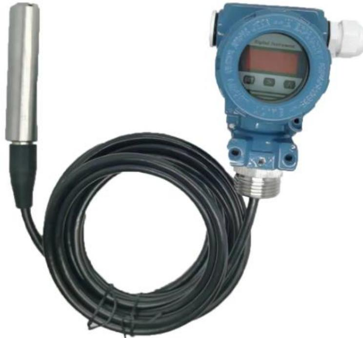
Nota: Sensor de nivel con salida de datos en RS485 que puede llegar a medir hasta 200m. Tomado por (XIDIBEI Sensor & Control, 2023).
