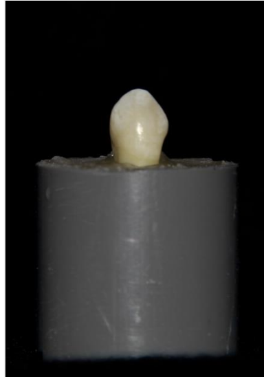
Fig.1. Premolar superior incluido en base de PVC, que servirá como probeta para el ensayo.
