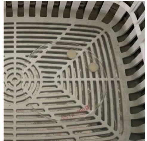
Limpieza de los especímenes a través de baño ultrasónico
