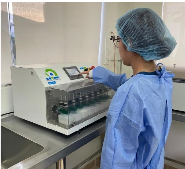
Configuración de los ciclos de la máquina de cepillado
