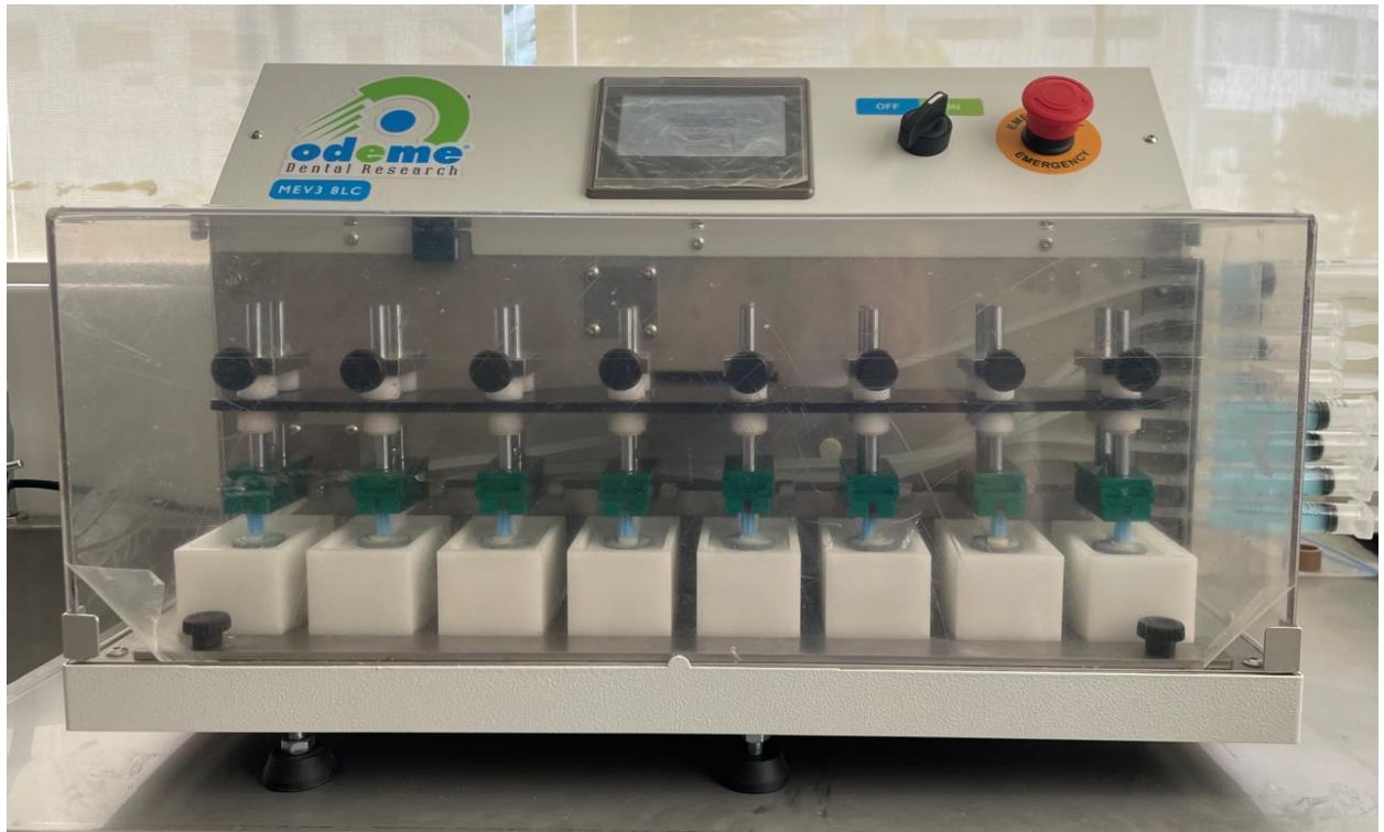
Cepillado simulado de los especímenes de resina en la máquina Odeme dental research; Joacaba SC, Brazil.
