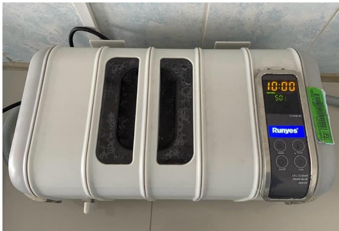
Limpieza de los especímenes a través de baño ultrasónico
