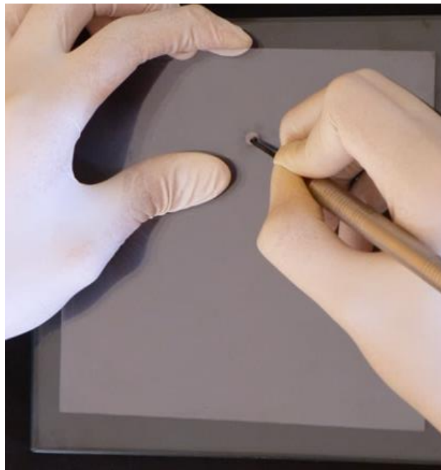
Figura Nro. 18. Retiro de la muestra con una espátula teflón
