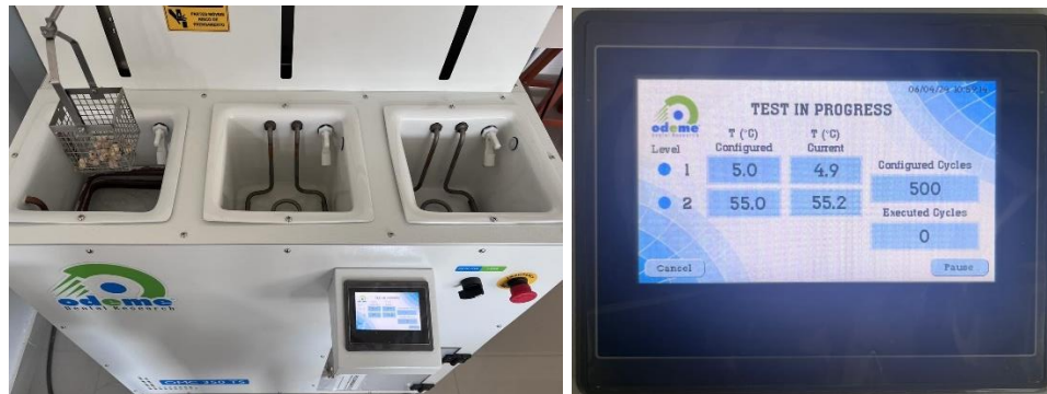
Figura 9-. Programación de 500 ciclos, tiempo de permanencia de 30 segundos, temperatura de 5C° y 55C° en dos pozos.
