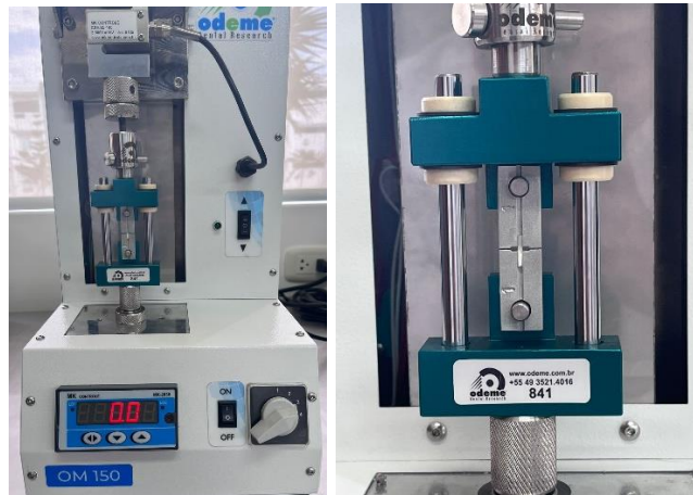
Figura 19-. Resistencia a la microtracción en una velocidad de 0.5mm/min.
