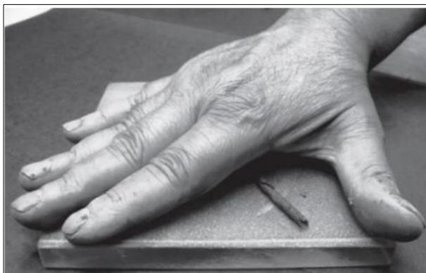
Nota. Trabajando sobre una superficie de vidrio para determinar el Límite Plástico mediante amasado. Tomado de Gutiérrez, (2022).
