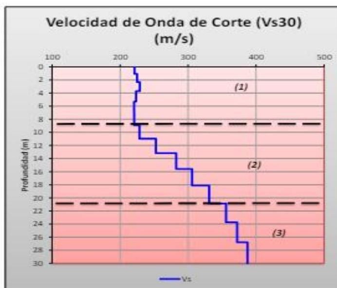
La primera línea sísmica, realizada con el ensayo Masw, muestra que la primera capa sísmica, posee datos de velocidad de onda S (Vs) que oscilan desde 220 m/s a 228 m/s, con un espesor de 8,90 m. Estratigráficamente, esta capa está constituida por una arcilla de consistencia blanda a media. La segunda capa, posee datos de velocidad de onda S (Vs) que varían entre 228 m/s y 330 m/s, con un espesor de 12,00 m, estratigráficamente esta capa, puede estar
