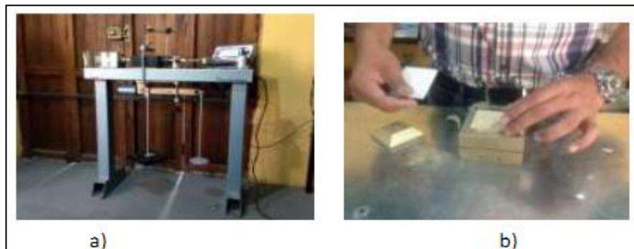
*Nota.* a) Equipo para prueba de corte directo semi automático 27-WF2060 b) Caja de corte de 6cmx6cmX2.50cm para la prueba de corte directo (Muñoz, 2020)
