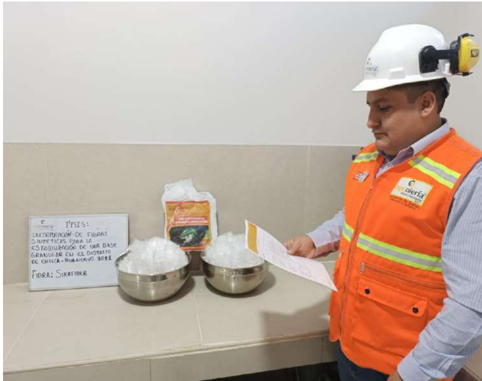
Foto N°01: Fibra usada para el mejoramiento en la estabilización de la sub base - Sikafiber
