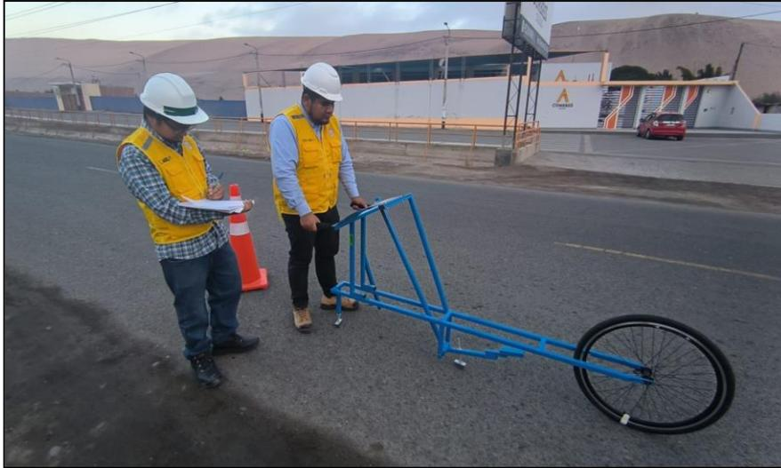
*Nota.* Obtención de datos utilizando el Merlin
