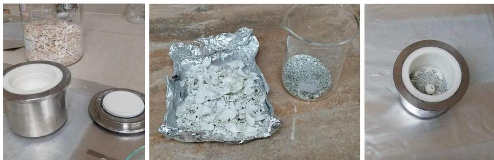
**Figura 1.** Procedimiento de preparación de muestras mediante molienda mecánica.
