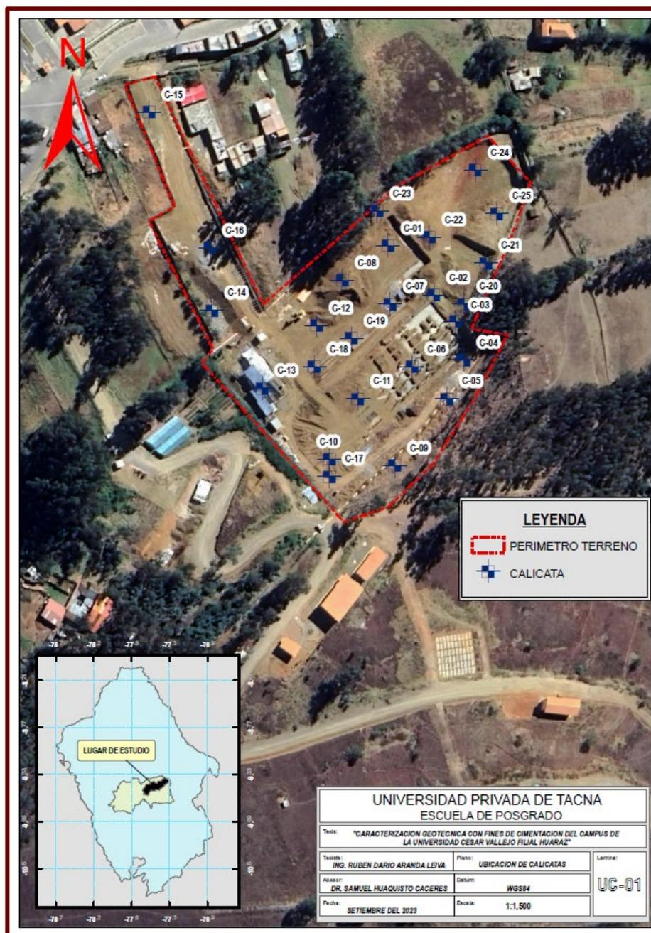
En la figura anterior se puede ver la distribución y cantidad de calicatas que se realizaron para la investigación, la cantidad de calicatas fue calculada de acuerdo a la norma E050 Suelos y cimentaciones, según la norma para el terreno que tiene un área de 17000 m<sup>2</sup> y ubicando una calicata cada 900 m<sup>2</sup> se requiere 19 calicatas como mínimo, pero en la investigación se realizó 25 calicatas en total, cumpliendo la exigencia de la norma.
