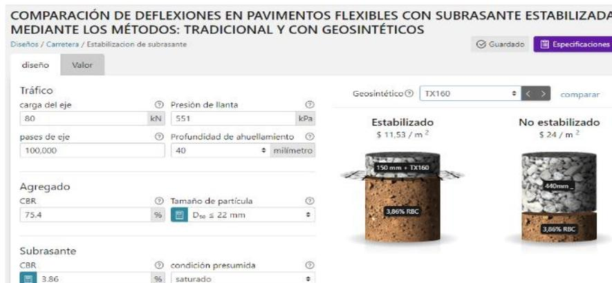
*Nota.* La figura muestra la comparación de las deflexiones con subrasante estabilizada con geosintéticos y mediante el método tradicional.
