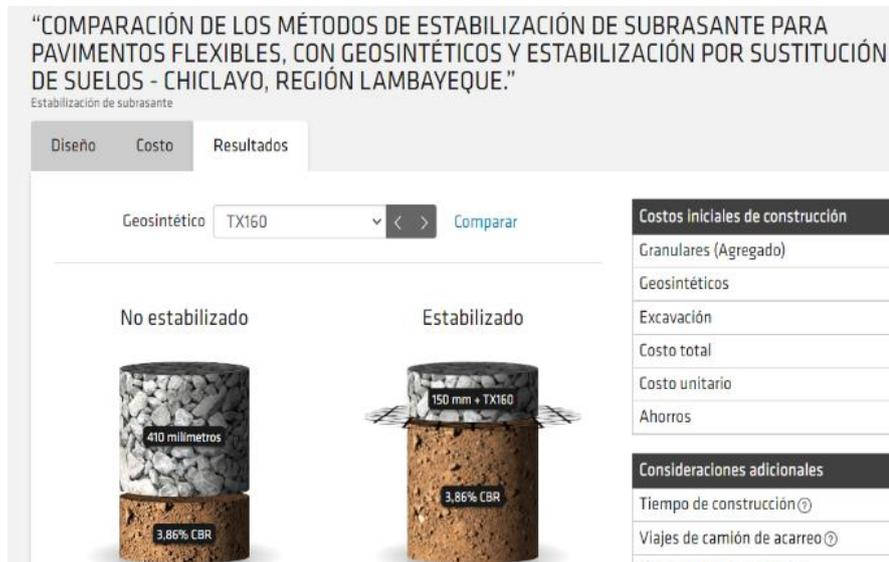
*Nota.* La figura muestra los resultados obtenidos de la estabilización de subrasante mediante el software Pave.
