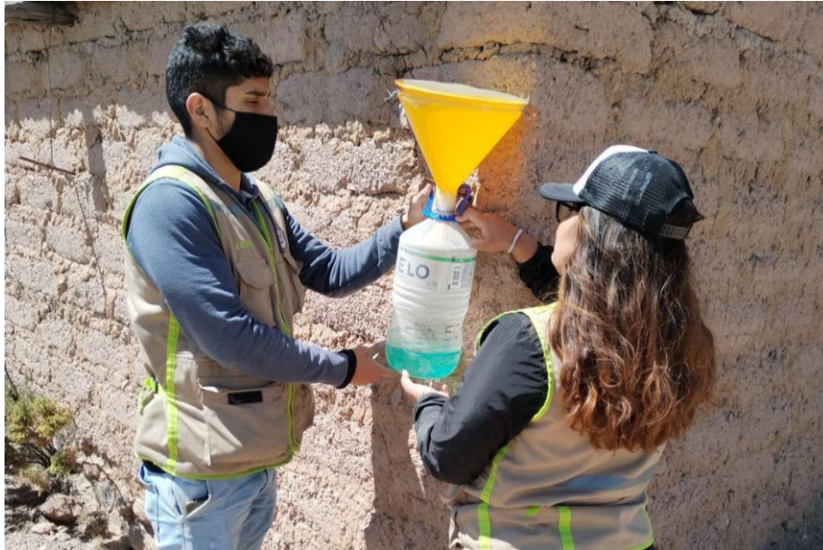
Fotografía 3. Instalación de los Colectores de Polvo en las Viviendas en la Comunidad Campesina de Santa Cruz - Ilabaya
