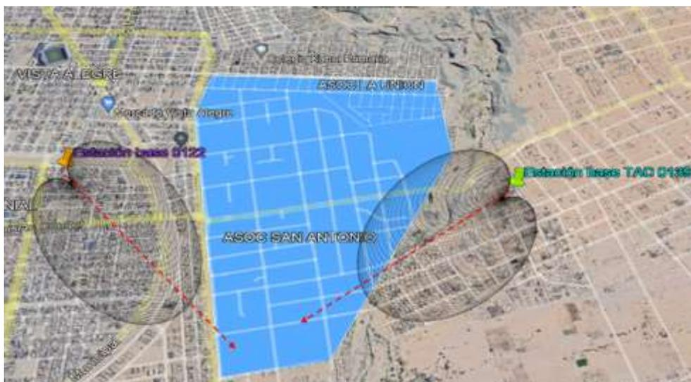
*Nota.* La línea roja indica la orientación de la antena en la Estación Base TAC 0122 (Az=135°) y de la Estación Base TAC 0139 (Az=223°)
