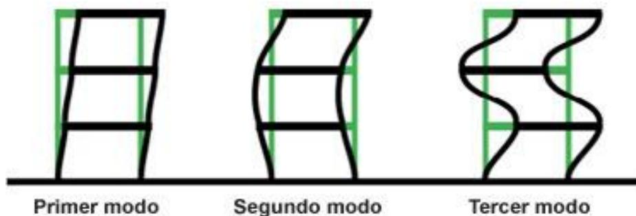
*Nota.* Se muestra los diferentes estilos de vibración que tiene el edificio y estas formas son llamadas modos de vibración. Adaptado de “Modos de vibración de una estructura” por Laboratorio de Ingeniería sísmica de la Universidad de Costa Rica, 2012.
