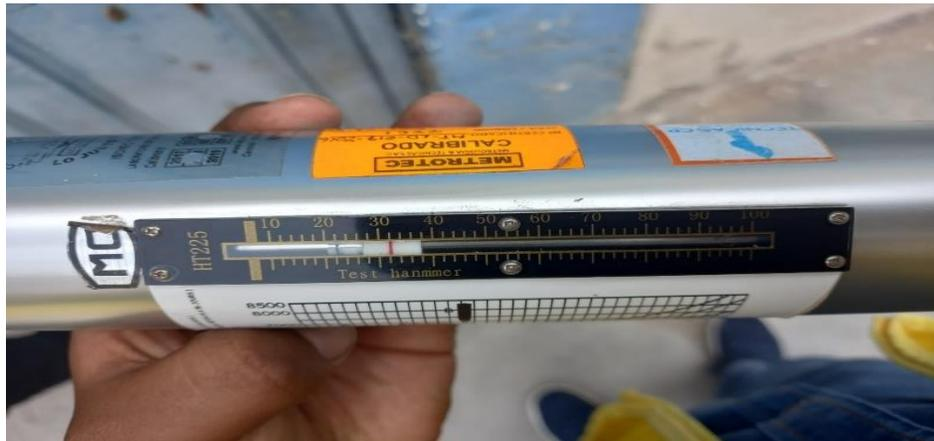
*Nota.* Se hizo uso del esclerómetro con lo cual se obtuvo la resistencia de compresión de los elementos estructurales.
