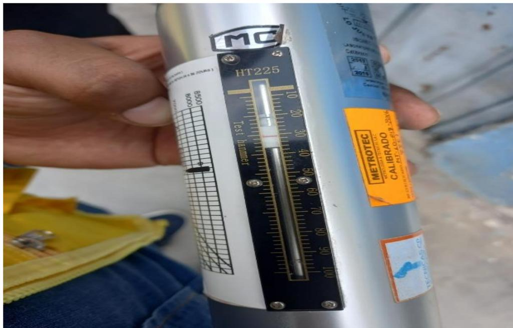
Nota. Esclerómetro adquirido por la Universidad Privada de Tacna utilizado en el ensayo en campo.
