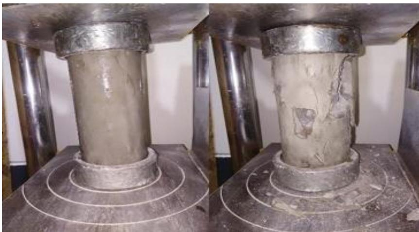
*Nota.* Ensayo de rotura de briquetas de concreto. ResearchGate subido por Humberto Pehovaz-Alvarez [Fotografía] ([https://www.researchgate.net/figure/Ensayo-de-resistencia-a-la-compresion-antes-y-despues-de-la-rotura\\_fig3\\_354459547](https://www.researchgate.net/figure/Ensayo-de-resistencia-a-la-compresion-antes-y-despues-de-la-rotura_fig3_354459547))
