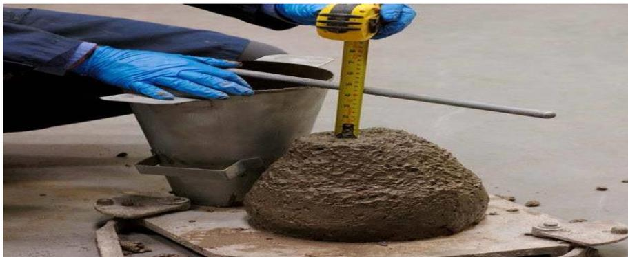
*Nota.* Ensayo utilizado para calcular la trabajabilidad del concreto. Tomado de civilgeeks.com [Fotografía] (<https://civilgeeks.com/2014/06/12/la-trabajabilidad-del-concreto-fresco/>)
