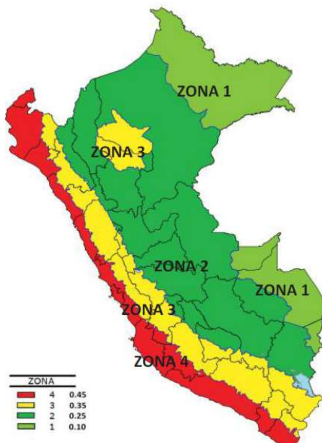
Figura 4. Mapa zonificación sísmica de Perú. El factor Z se interpreta como la aceleración máxima horizontal en suelo rígido con una probabilidad de 10% de ser excesiva en 50 años.
