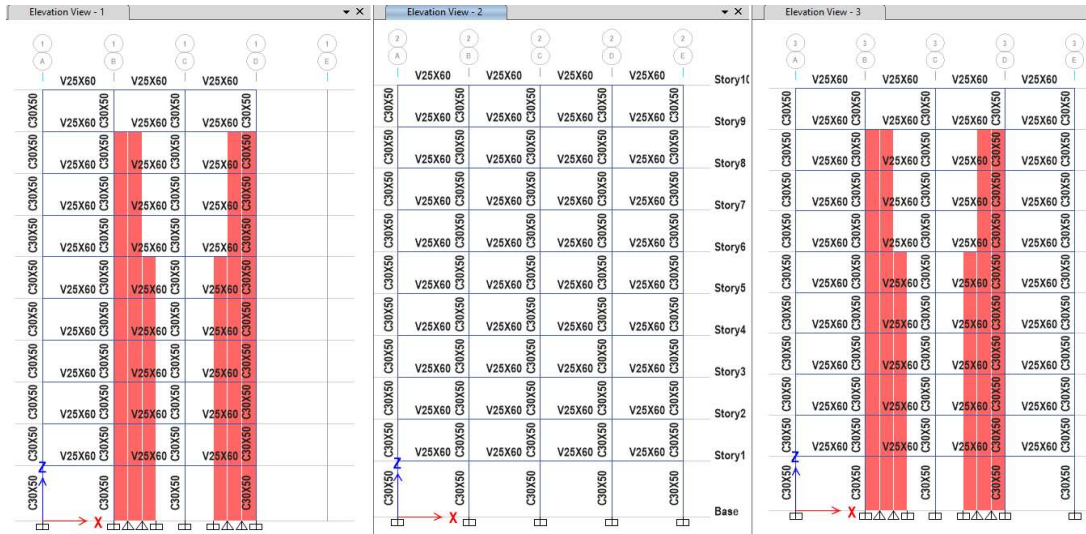
Figura 54. Irregularidad por esquinas entrantes (10 N.)
