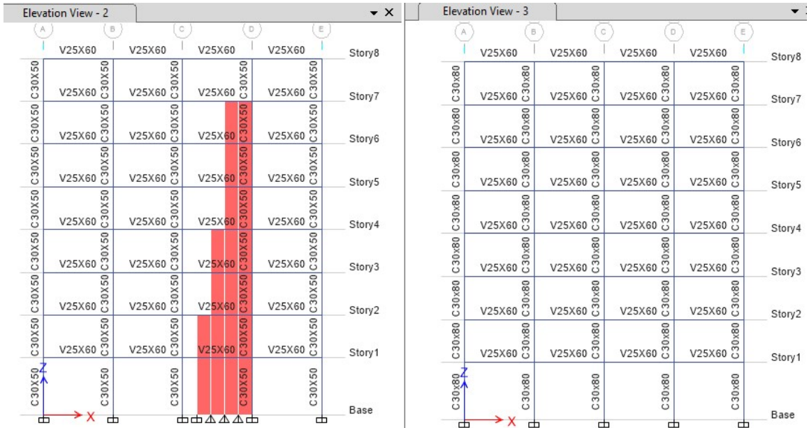
Figura 44. Irregularidad Torsional (8 N.)
