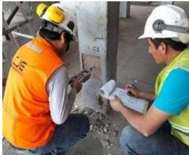
*Nota.* Uso del esclerómetro. Fuente: Laboratorio CJE ingenieros SAC.
