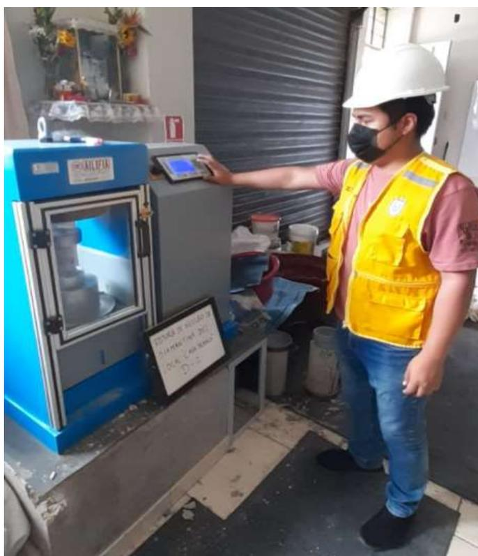
Nota. En la figura podemos observar el momento de la realización del ensayo de compresión a las muestras extraídas.
