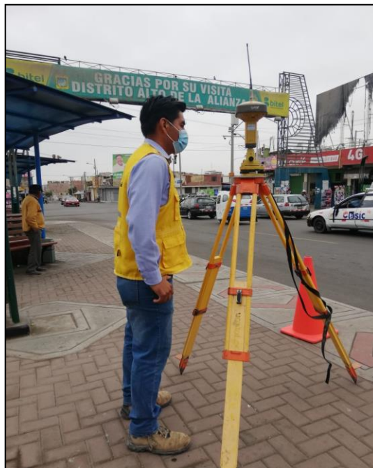
Fotografía 9. Levantamiento topográfico realizado con GPS diferencial TOPCON.
