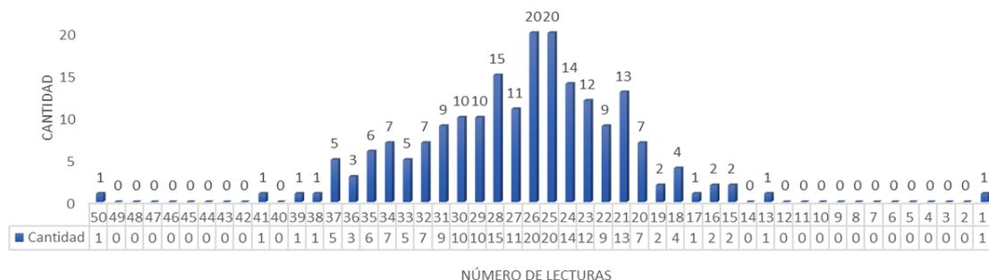
Continuando con el procedimiento de cálculo en la muestra 03 con progresiva 0+800 al 1+200, se obtiene un histograma de frecuencias (figura 38), un valor IRI de 4,10 m/km. Ver anexo 02.
