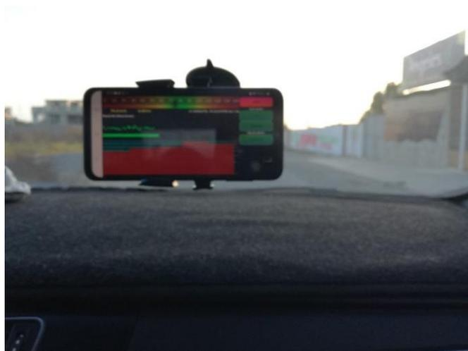
C. Se procede a configurar el coeficiente de reajuste con valor 3 y tipo de cálculo estadístico. Luego se inicia la aplicación abakal IRI y presiona el botón de conteo, ahora el aplicativo IRI tomando datos durante el recorrido del vehículo (figura 27).
