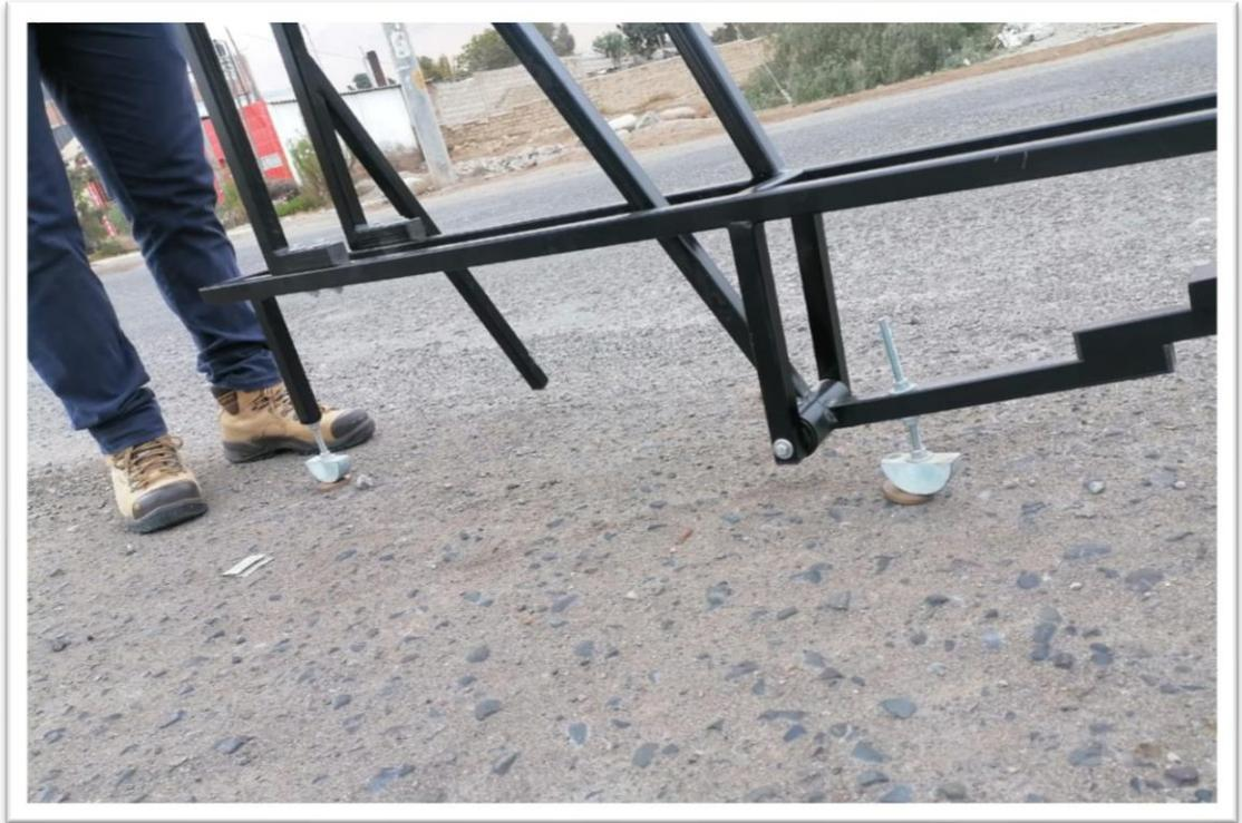
Calibración con las pastillas del equipo Merlin
