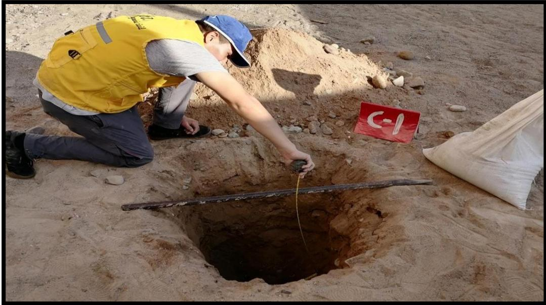
*Nota.* La figura muestra la calicata que se realizó para determinar por medio de ensayos de laboratorio el CBR de diseño. Elaboración propia.
