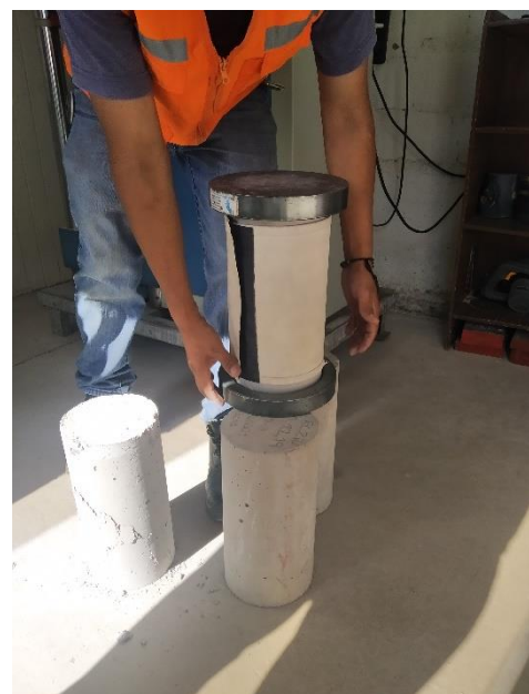
FIGURA 72: Preparación de briquetas para concreto en losa (obra 3)
