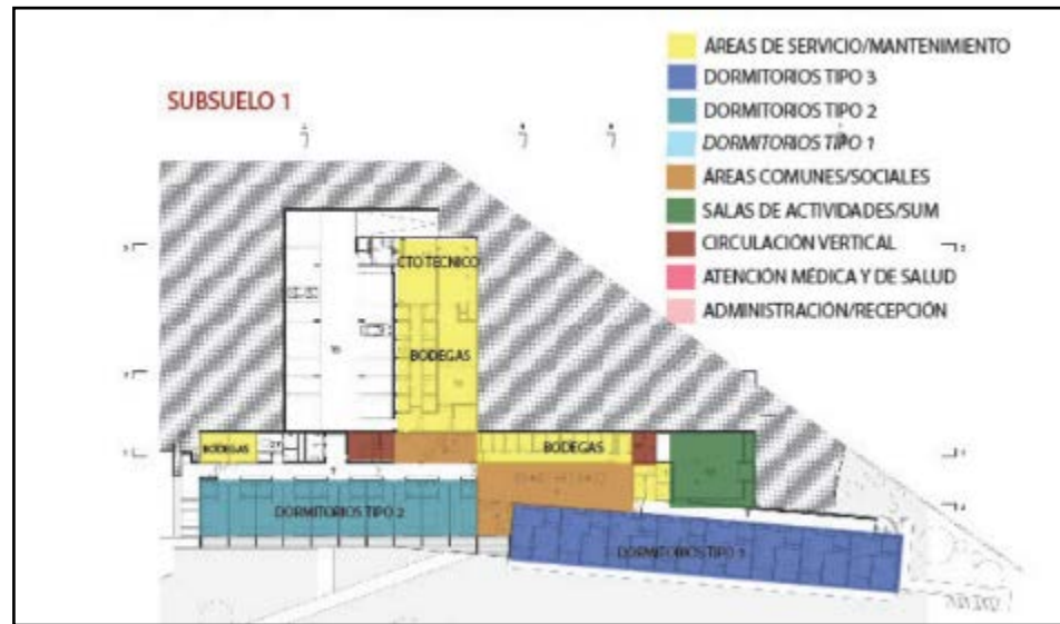
FIG. N° 37. IMAGEN ZONIFICACION SUBSUELO 1
