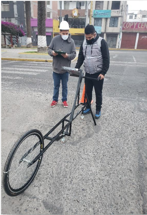
Fotografías: Calibración y obtención de datos de campo utilizando el rugosímetro de MERLIN, carril derecho
