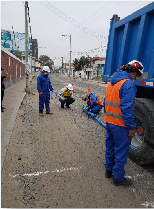
Fotografías: Ajuste de los diales de lectura y nivelación de la Viga Benkelman, y toma de lecturas.
