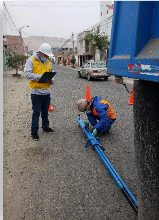
Fotografías: Posicionamiento del vehículo en el punto de lectura, y toma de lecturas.
