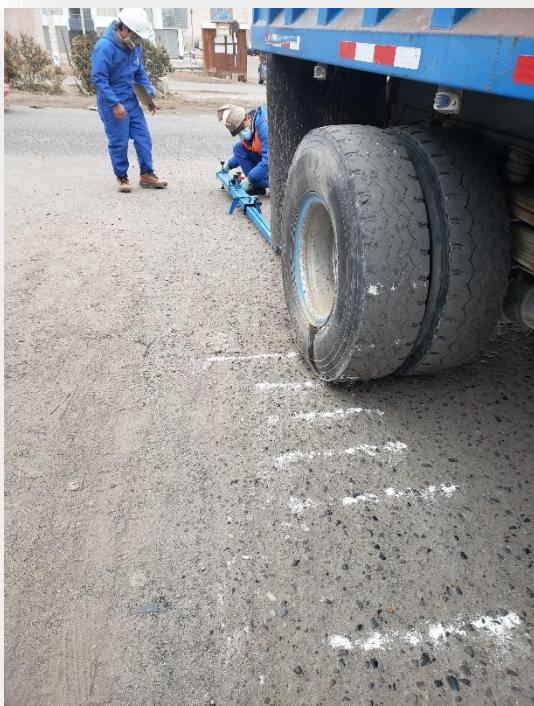
Fotografías: Posicionamiento del vehículo en el punto de lectura, y toma de lecturas.
