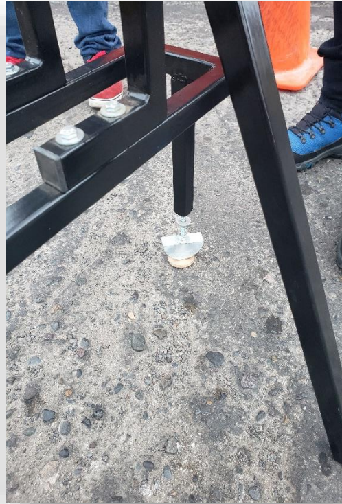
Fotografías: Calibración y obtención de datos de campo utilizando el rugosímetro de MERLIN, carril derecho
