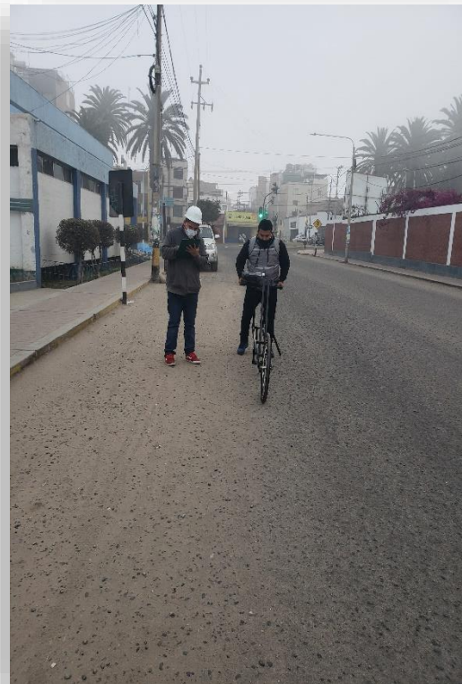
Fotografías: Obteniendo datos de campo utilizando el rugosímetro de MERLIN, carril izquierdo.
