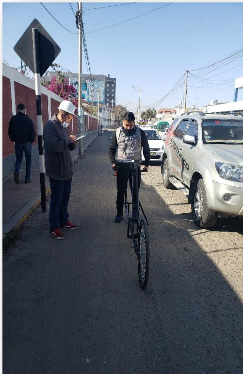
Fotografías: Obteniendo datos de campo utilizando el rugosímetro de MERLIN, carril izquierdo.
