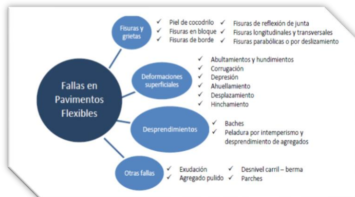
Figura N° 04: Fallas en pavimentos flexibles Fuente: (Corros, 2015)
