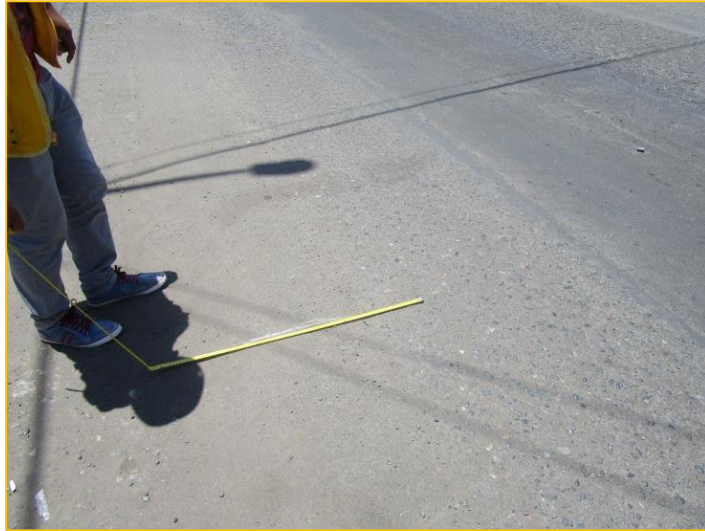
Figura 107: Toma de medidas para el ensayo de la Viga Benkelman.
