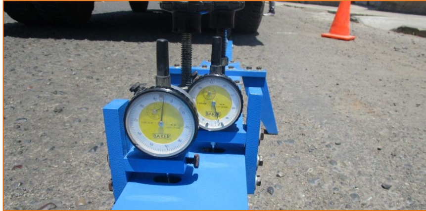
Figura 88: Calibración de los diales de la Viga
