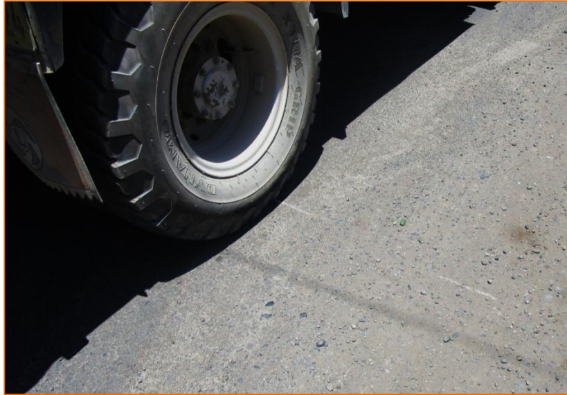
Figura 85: Colocación de la Rueda dual en el punto de ensayo
