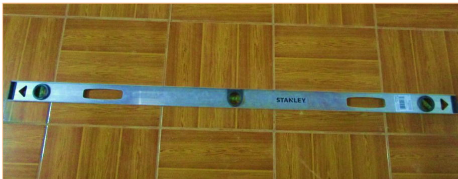
Figura 22: “Regla para Nivel de 1.20 m” - (Fuente Propia)
