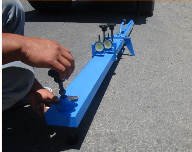
Figura 87: Fijación de la Viga Benkelman
