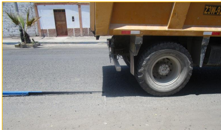
Figura 109: Avance del Camión para la toma de medidas.
