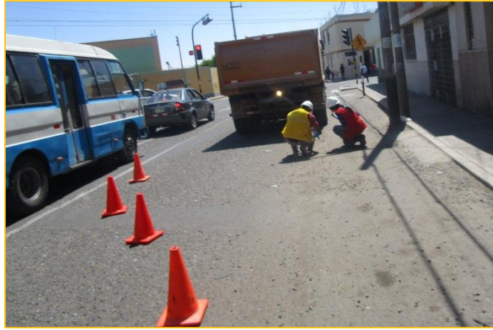
Figura 110: Colocación de la Viga Benkelman - Carril Derecho.
