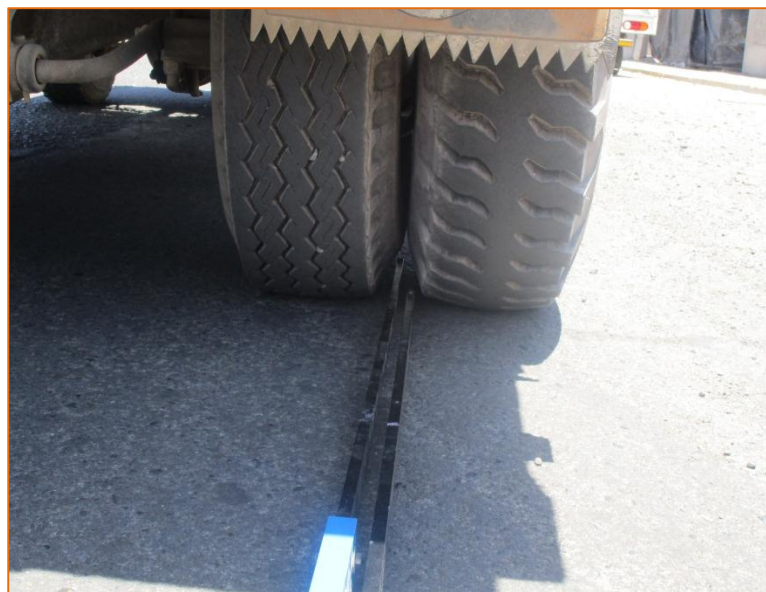
Figura 86: Colocación de la Viga Benkelman en el punto de ensayo
